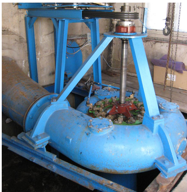
Obr. 6: Kaplanova turbína od společnosti Chlouba s.r.o.
