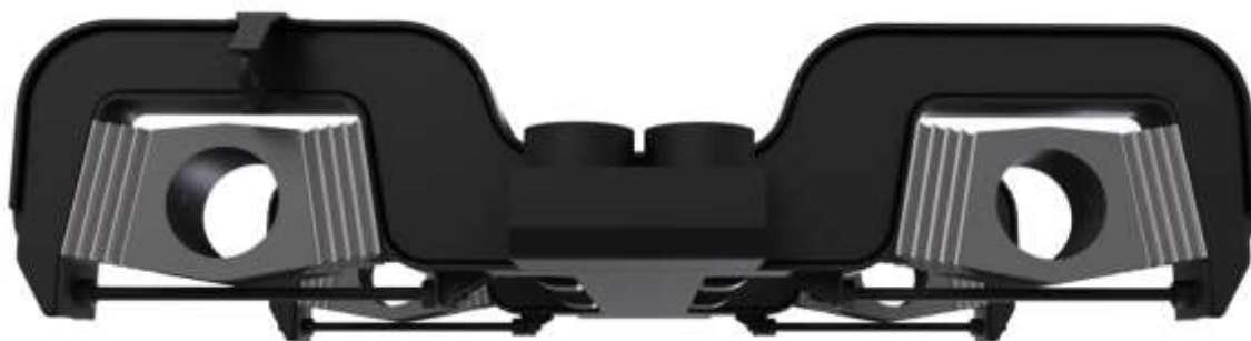
Obrázek 43 - Ložisková skříň vložena do podélníků
