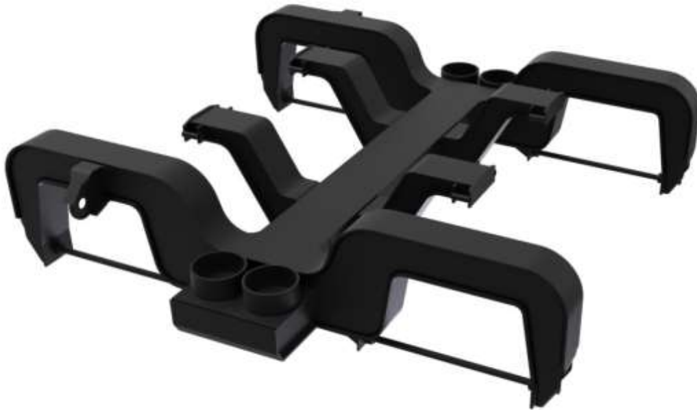
Obrázek 39 – Nalakovaný rám černou barvou včetně konzol pro pružiny a brzdy
