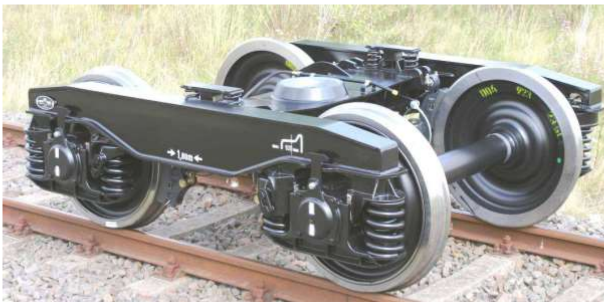
Obrázek 9 - Podvozek Y27 - svařovaný rám [12]
