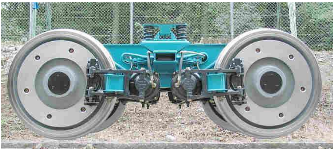
Obrázek 23 - Podvozek LEILA DG [26]
