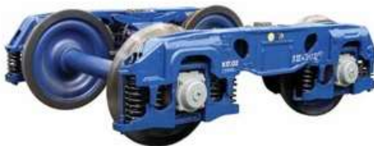
Obrázek 20 - Podvozek AM III pro zatížení 25t na nápravu [23]
