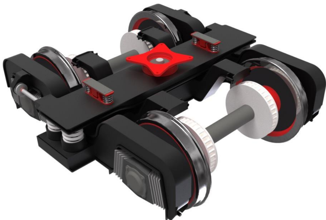
Izometrický pohled na koncepční podvozek Y27
