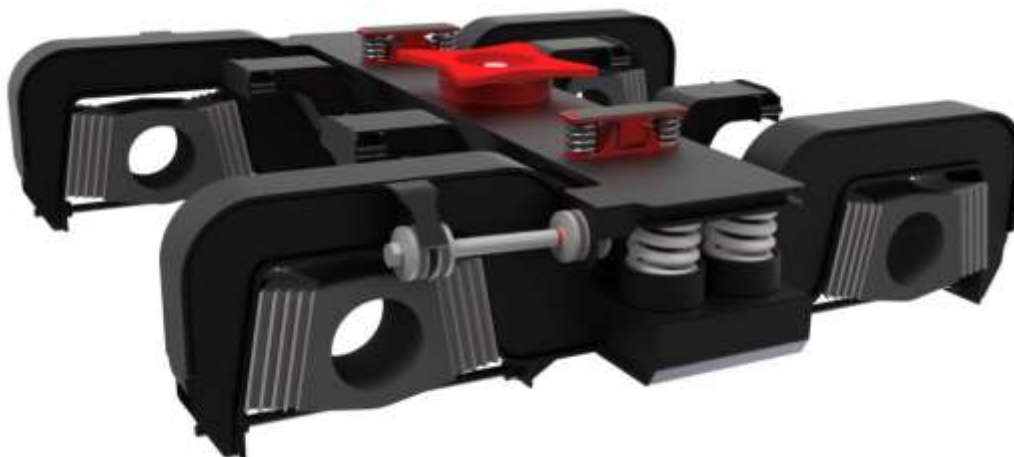
Obrázek 49 - Táhlo přichycené k rámu a ke kolébce
