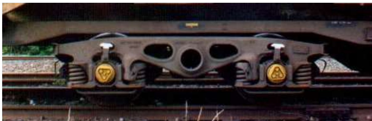
Obrázek 10 - Podvozek Y27 - odlévaný rám [13]
