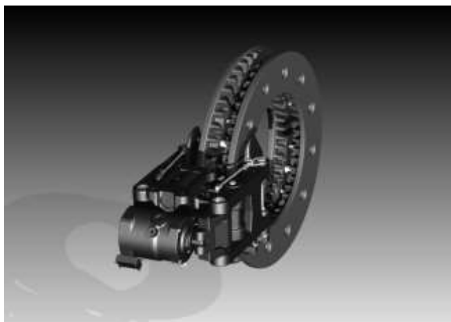
Obrázek 35 – brzdová jednotka kotoučové brzdy [30]
