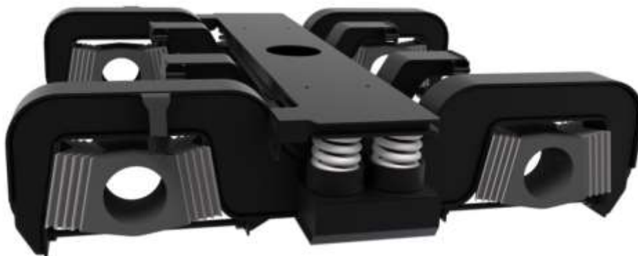
Obrázek 44 - pohled na sekundární vypružení s kolébkou
