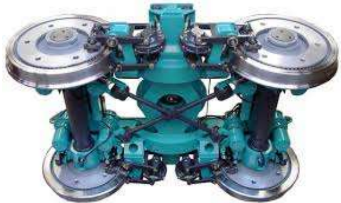
Obrázek 22 - Podvozek LEILA s křížovou vazbou [25]
