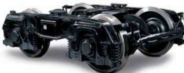
Obrázek 21 - Podvozek AM III pro zatížení 30t na nápravu [24]
