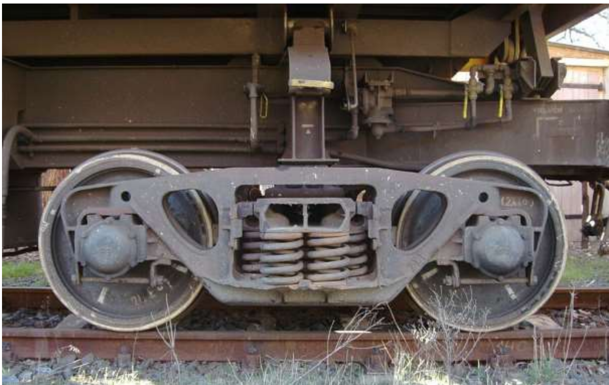
Obrázek 4 – odlévaný podvozek Diamond [8]
