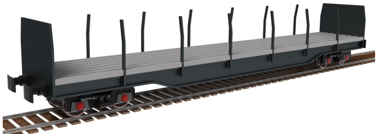
koncepční návrh plošinového vozu s novými podvozky Y27
