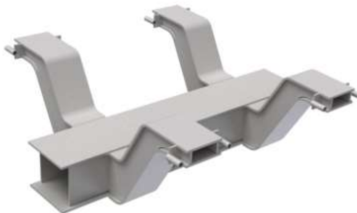
Obrázek 37 – Příčník s konzolemi pro uchycení brzd
