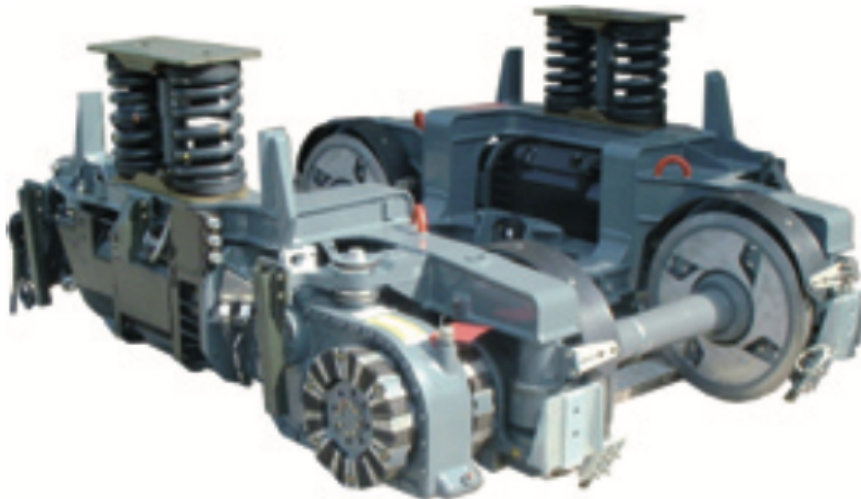
Obr. 5: Podvozek FLEXX Urban 1000 [4]
