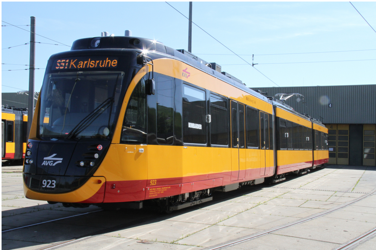
Obr. 7: Tram-train FLEXITY Swift využívající podvozek FLEXX Urban 2500 [14]
