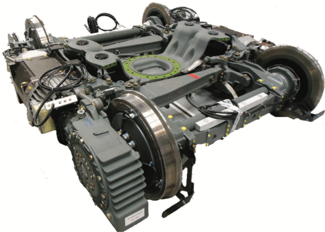
Obr. 15: Otočný podvozek Ipomos [6]
