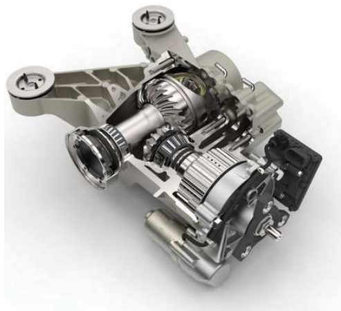
Obrázek 12 Spojka Haldex [2.4.6]
