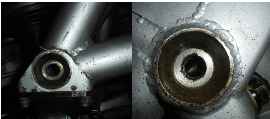
Obr. 7-5 Otvory pro upevnění lyže v karoserii (vlevo) a v nápravnici vozu (vpravo)
