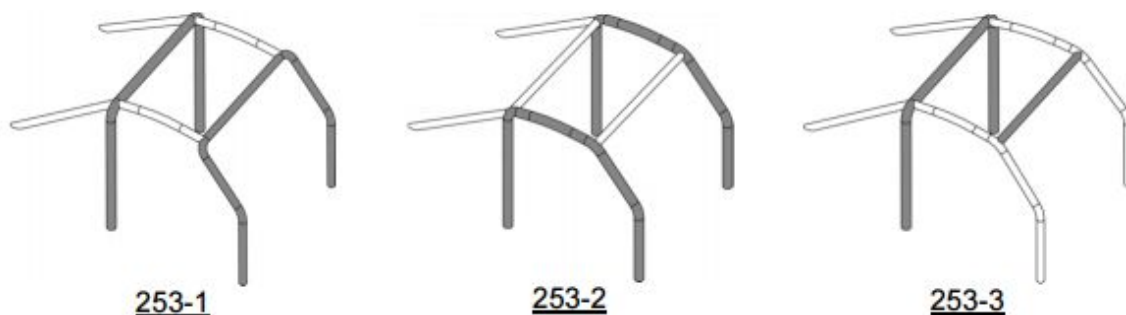
Obr. 4-1 Zobrazení základních částí rámu (bezpečnostní konstrukce) [8]
