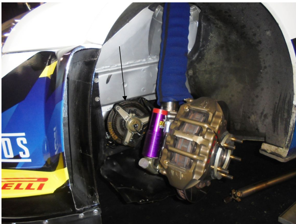
Obr. 6-4 Umístění spojky v prostoru levého předního kola (spojka označena šipkou)
