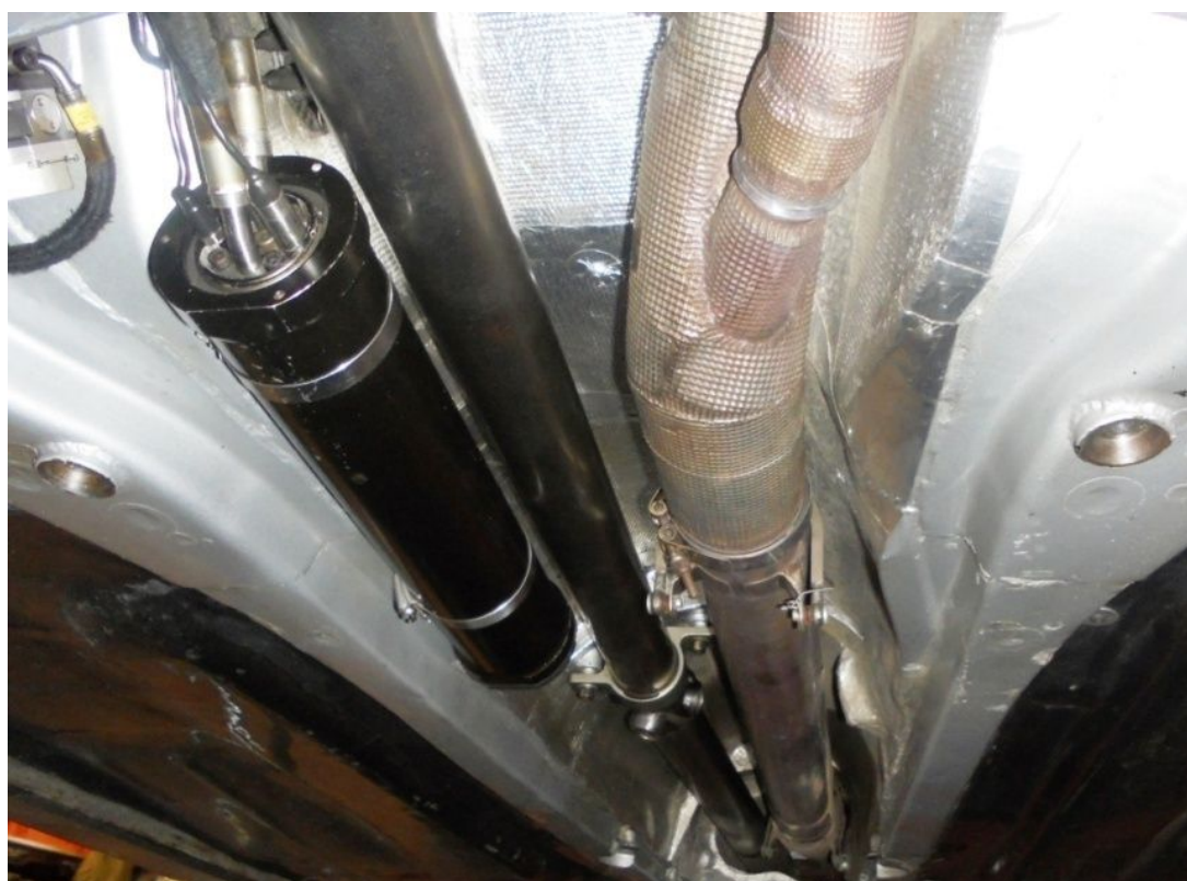
Obr. 7-7 Pohled na část podvozku zakrytého lyžinou (v levé části zásobník hydrauliky, uprostřed kardanova hřídel a v pravé části výfukové potrubí)
