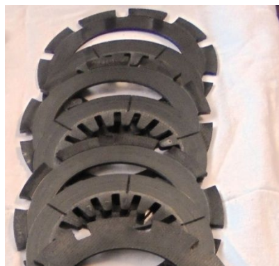
Obr. 6-9 Karbonové lamely s vnitřním a vnějším ozubením (č. 11 na rozpadu sestavy spojky)
