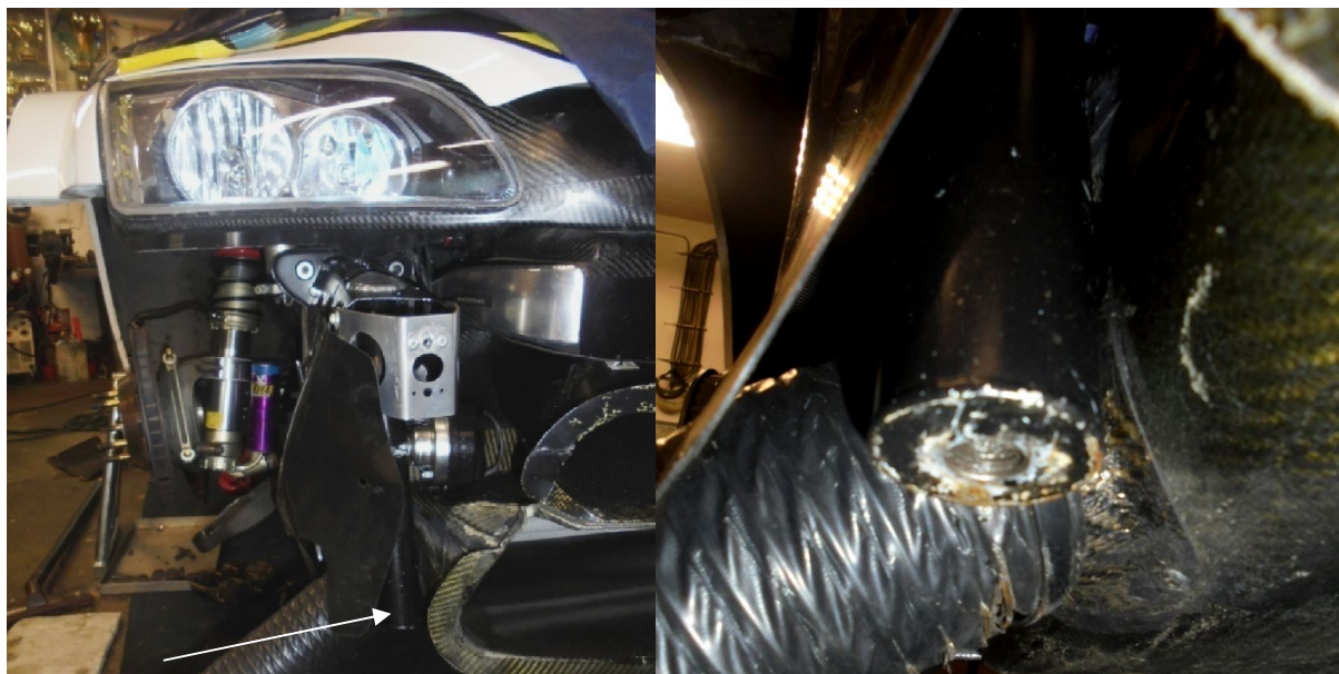
Obr. 7-6 Přední úchyt lyžiny, jeho umístění označené bílou šipkou (vlevo) a detail (vpravo)
