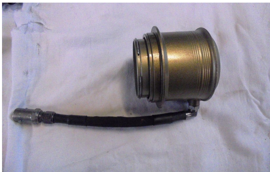
Obr. 6-15 Hydraulické ovládání výšky vozu (nasazeno na tělo tlumiče pod trubkou tlumiče)
