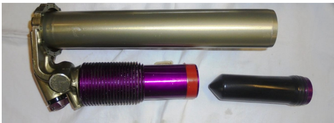
Obr. 6-14 Detail těla tlumiče s nádobkou pro olej a pryžovým vakem na stlačený dusík
