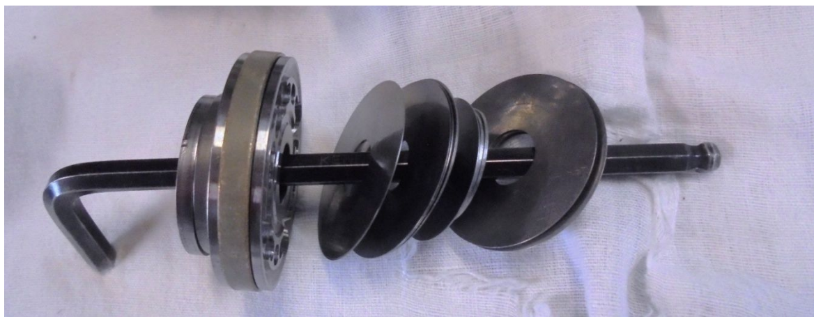
Obr. 6-13 Detail demontovaného svazku tlumících planžet (č. 14 na rozpadu sestavy tlumiče)
