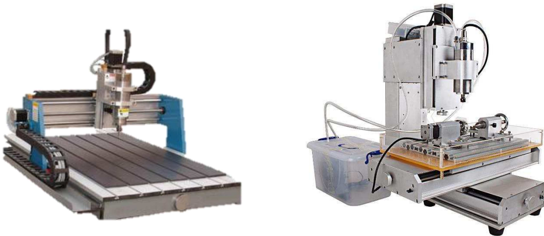
Obr. 2-6: Provedení rámu - zleva uzavřený rám a vpravo otevřený rám [8]
