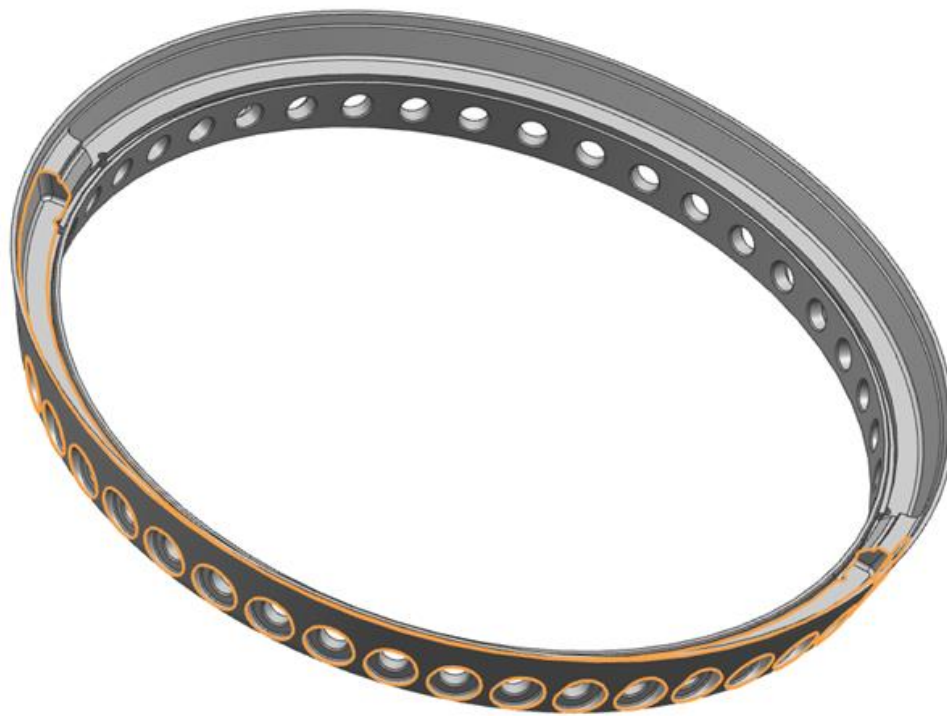
Obrázek 9: Osmá operace – ostré hrany určené k odjehlení (souměrně platí pro druhou půlku)
