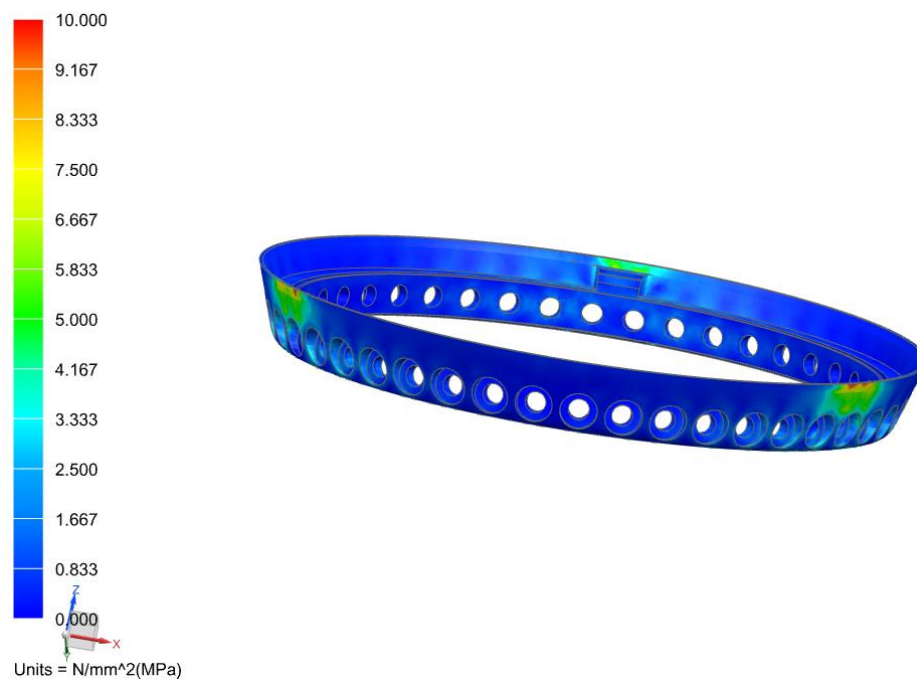
Obrázek 40: Napětí Von-Mises – materiál Inconel 718
