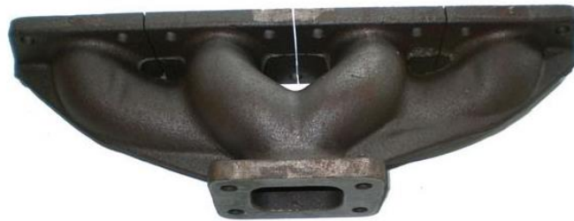
Obrázek 33 Sběrné potrubí ze šedé litiny [34]
