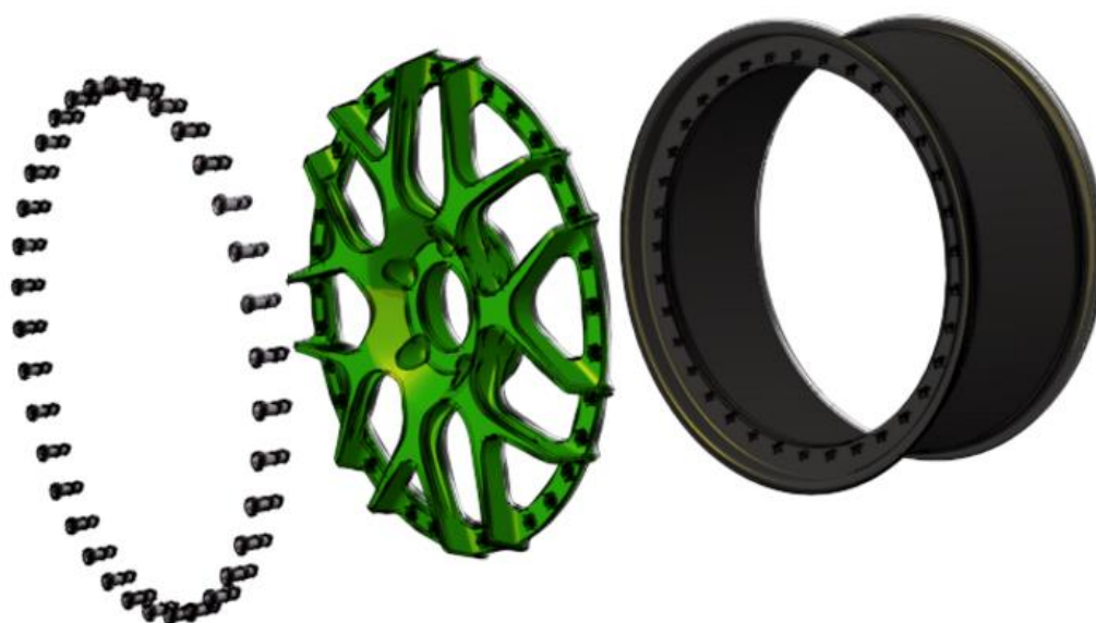
Obrázek 9: Nejčastější řešení kompozitních disků [7]
