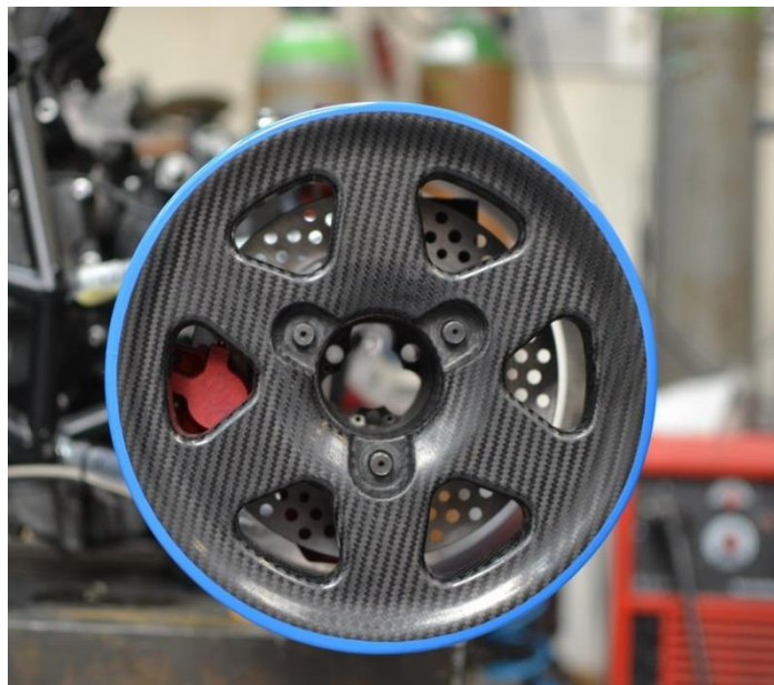
Obrázek 5: Celokompozitní disk kola týmu CTU Cartech [3]
