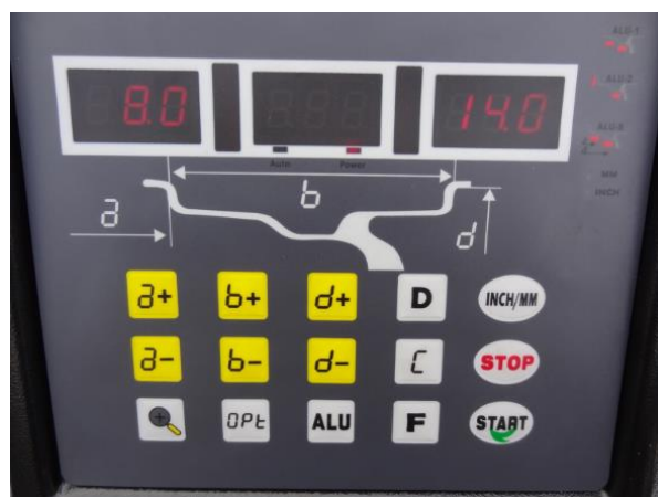
Obrázek 12: Ovládací rozhraní vyvažovacího přístroje [6]
