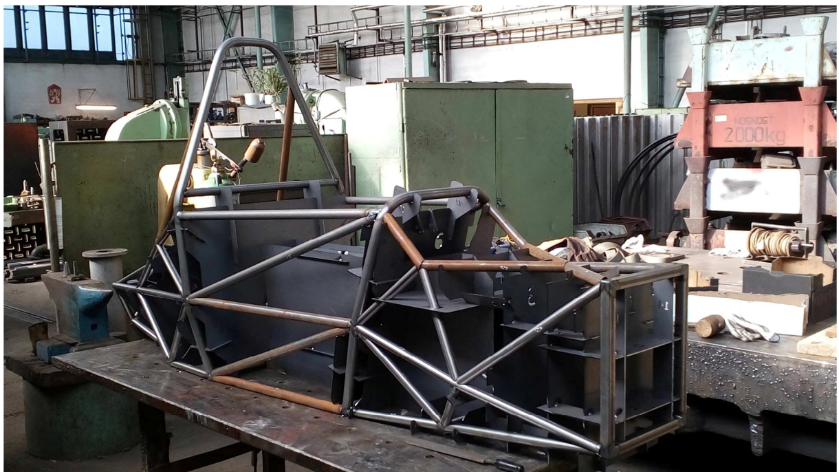
Obrázek 34 – Alternativní rám s přípravkem na svařování zepředu
