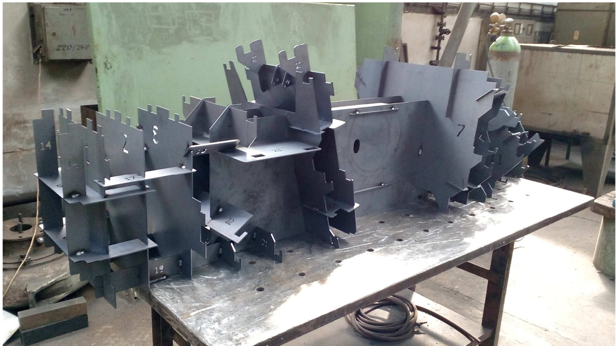
Obrázek 32 – Přípravek pro svařování rámové konstrukce
