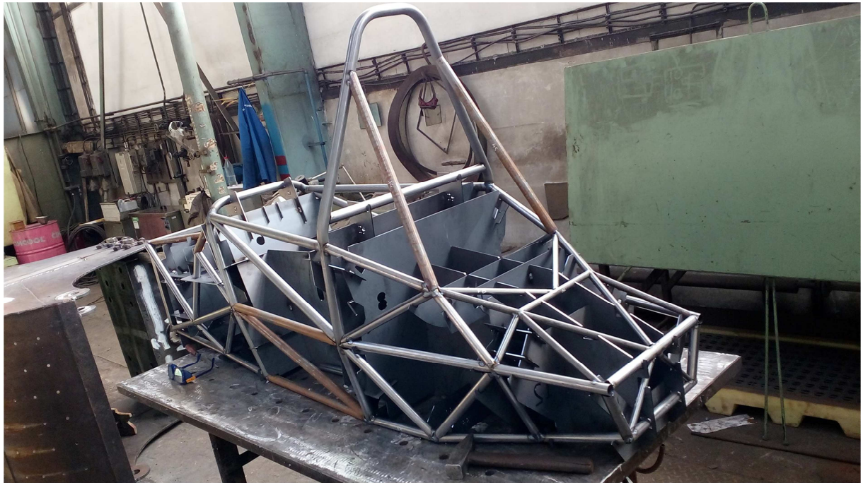
Obrázek 33 – Alternativní rám s přípravkem na svařování zezadu
