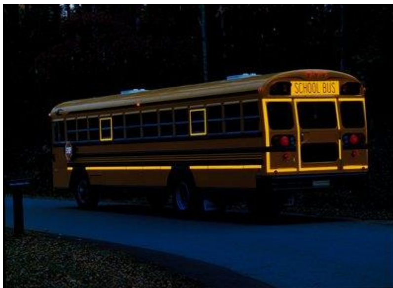
Obrázek 19 Reflexní samolepky na karoserii autobusu [29]
