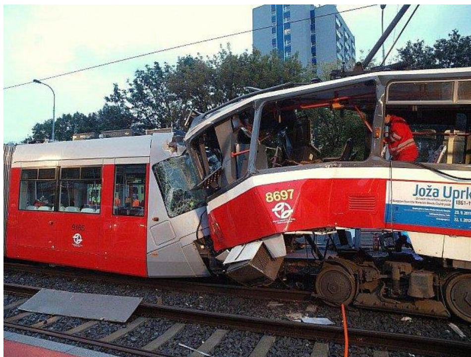
Obrázek 1 Ukázka rozdílných pevností čel tramvají při střetu 0
