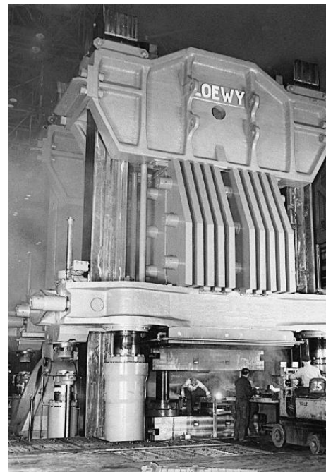
Obr. 1.6 Hydraulický lis pro zápustkové kování LOEWY 500MN [9]
