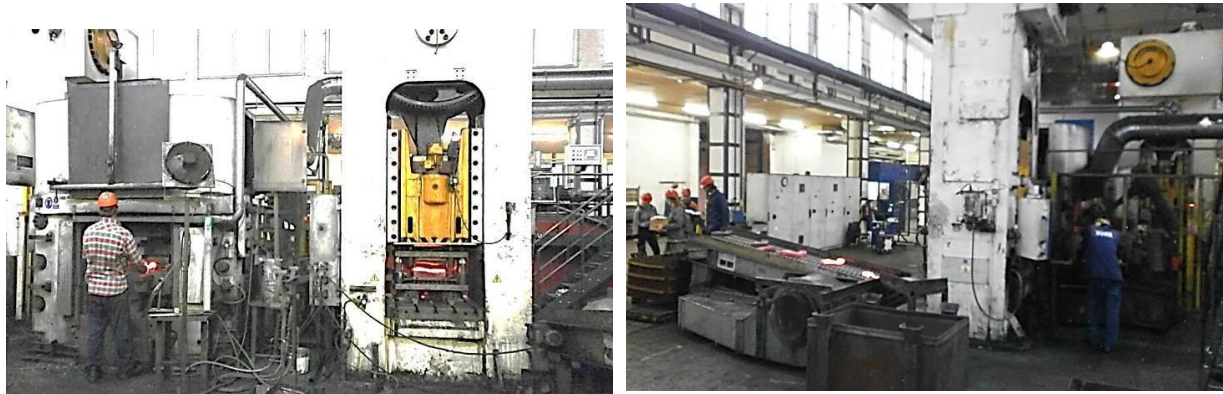
Obr. 4.7 Kovací lis (vlevo) a ostřihovací lis (vpravo)
