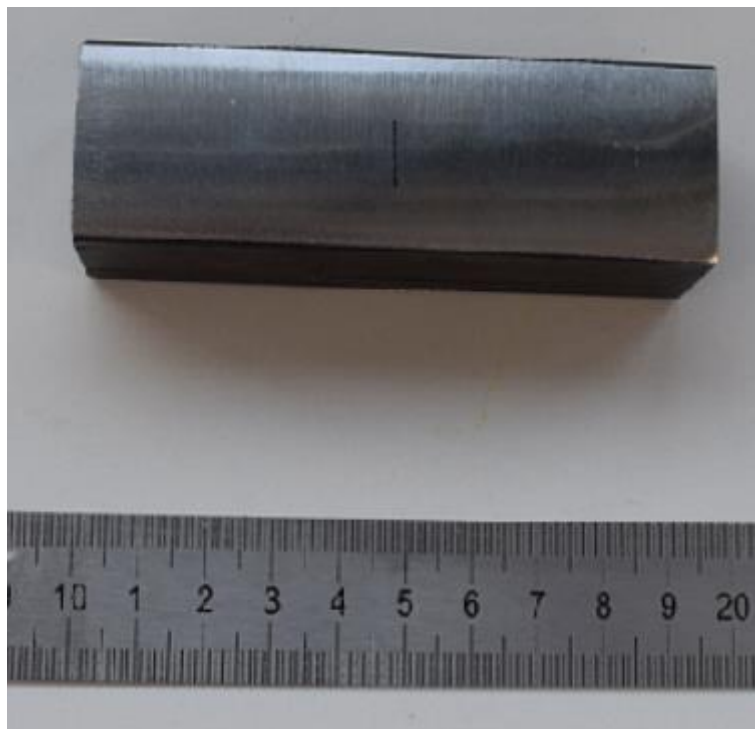
Obr. 37 - Vzorek č. 15 s vyjiskřenou drážkou
