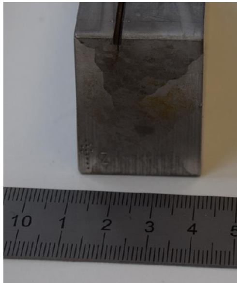
Obr. 36 - Detail svaru na polotovaru pro vzorek č. 10
