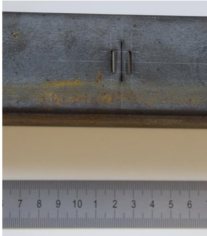
Obr. 38 - Detail připravených drážek na polotovaru pro vzorky č. 11 a 14
