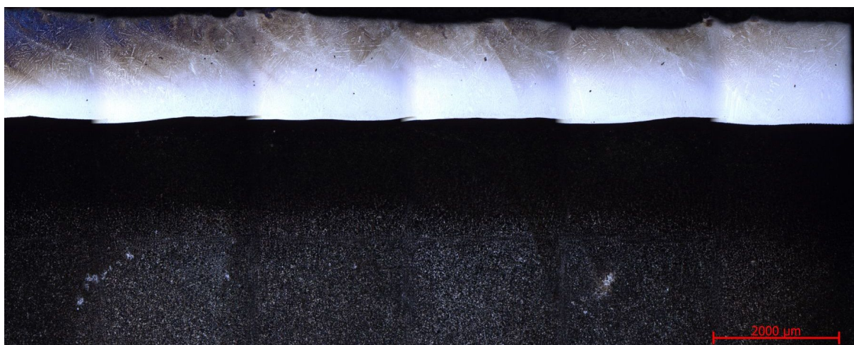
Obr. 7.3.5- vzorek s 2 hm. % Mo, leptadlo Adler, zv. 25x
