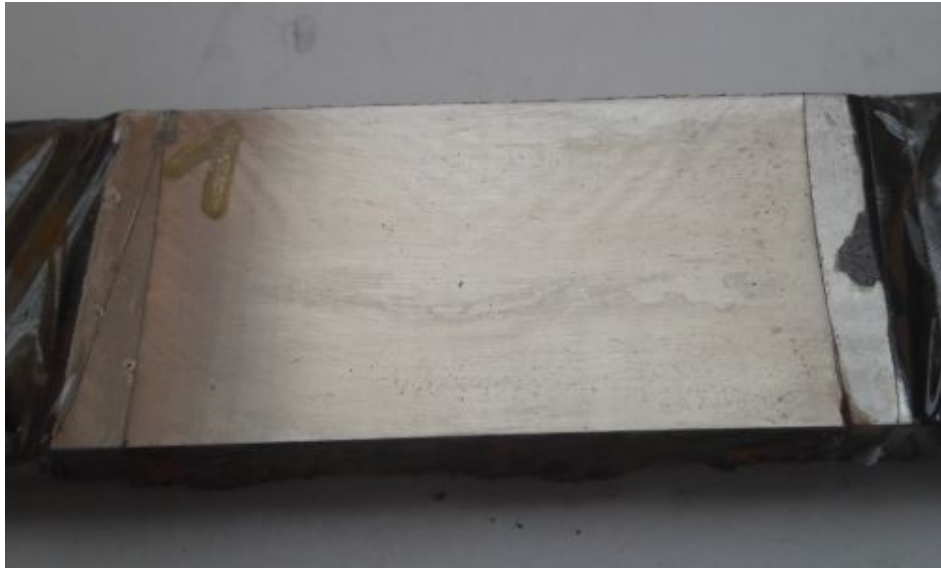
Obr. 7.5.4- vzorek bez přidaného molybdenu po provedení testu v solné mlze
