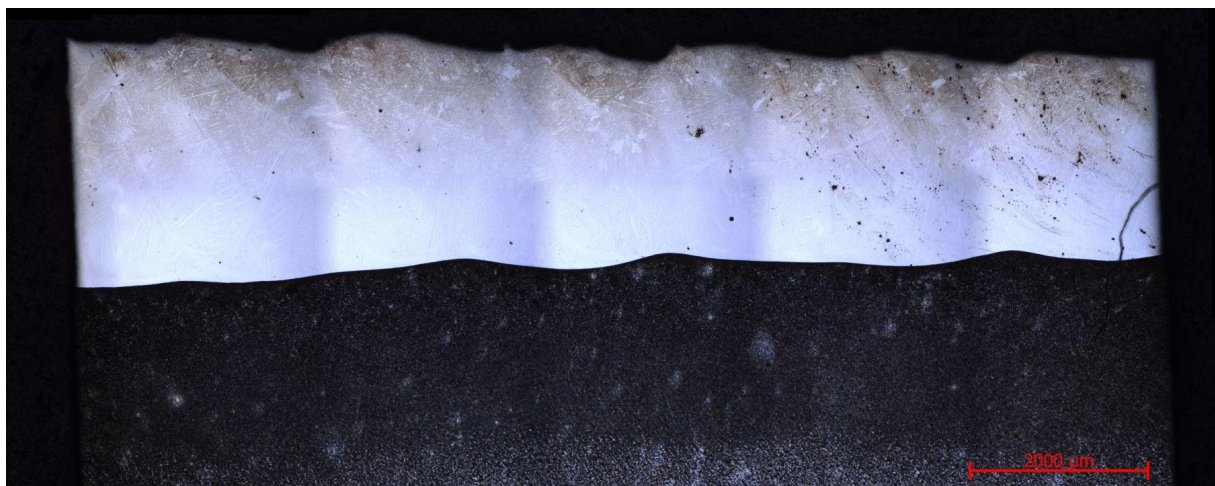
Obr. 7.3.2- vzorek s 0,5 hm. % Mo, leptadlo Adler, zv. 25x
