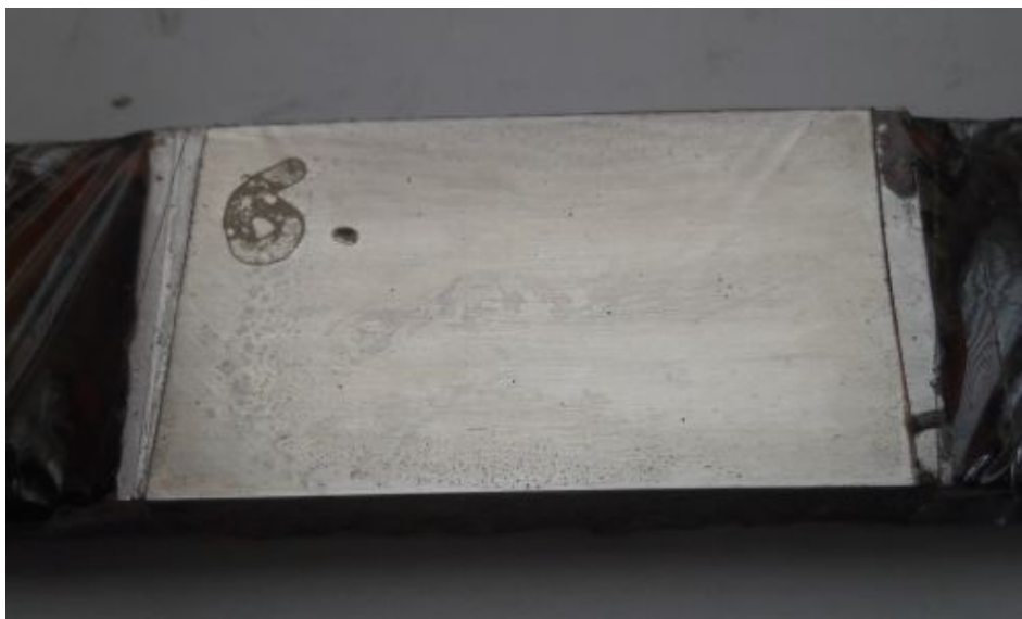
Obr. 7.5.4- vzorek s 2,5 hm. % Mo po provedení testu v solné mlze
