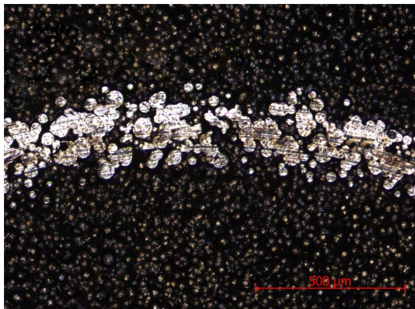
Obr. 60 – Opotřebení povlaku PCr po testu PIN-on-DISC v oleji
