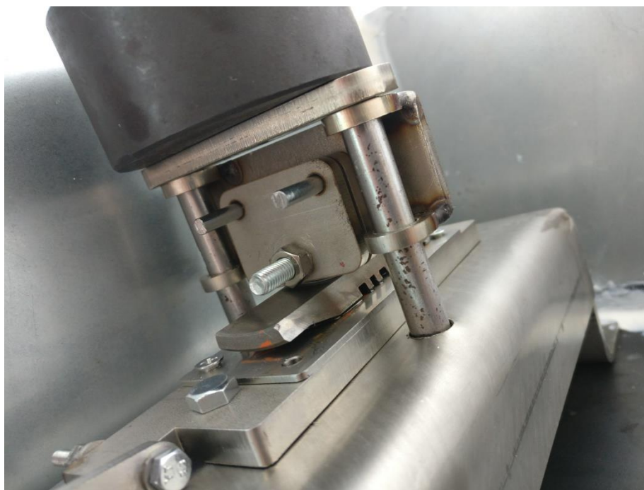
Obr. 76 – Uchycení segmentu pístního kroužku s protikusem na podložce
