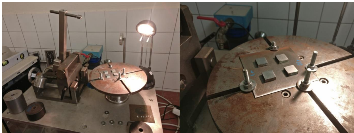
Obr. 53 – Tribometr a detail uchycení vzorků při testu
