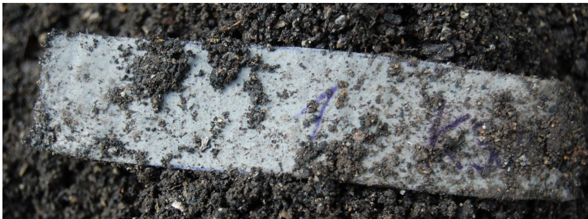
Obr. 34 ukázka vzorku K30Cl po 4 týdnech v půdním prostředí
