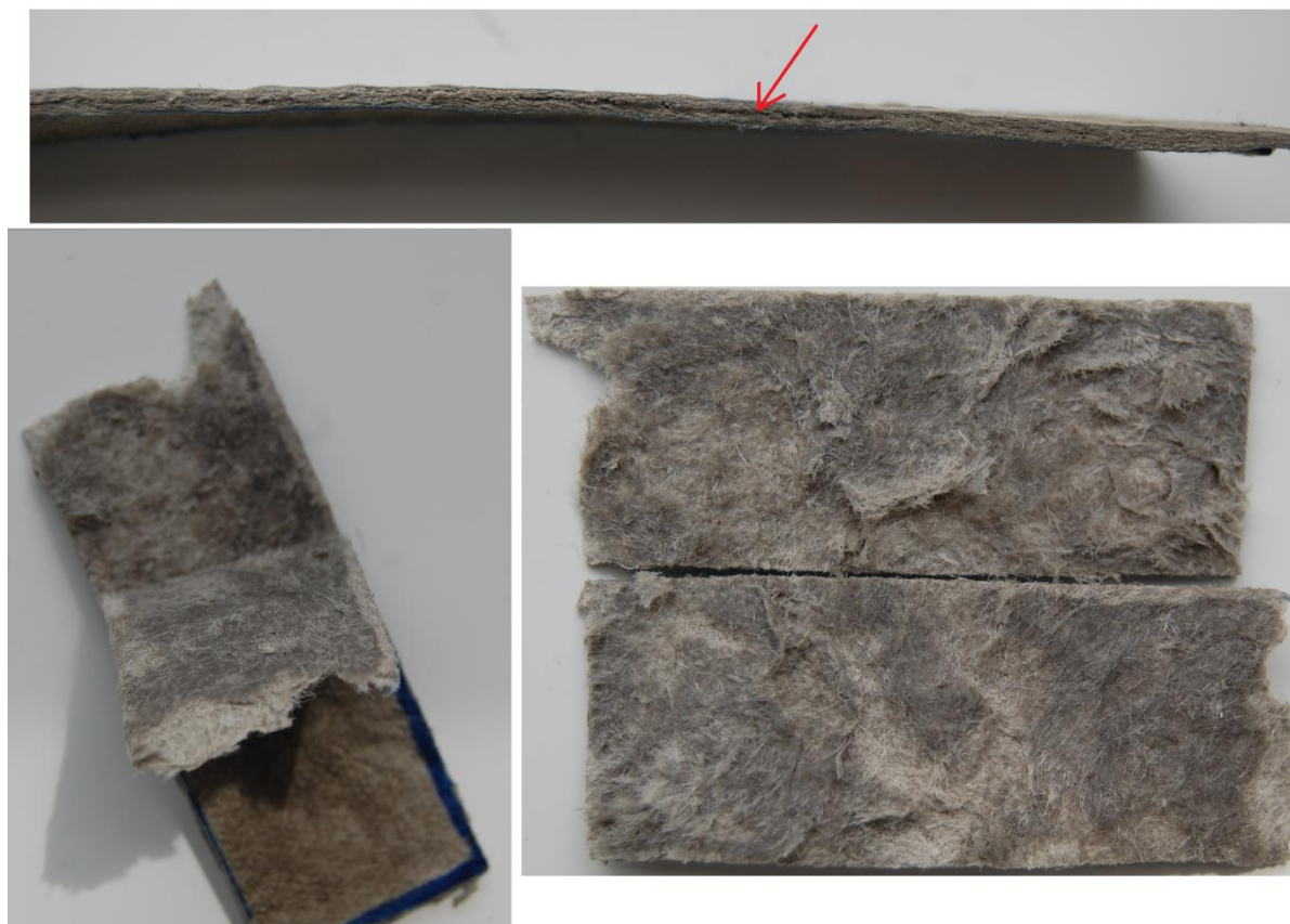
Obr. 27 ukázka kritických míst hydrofobizovaného vzorku
