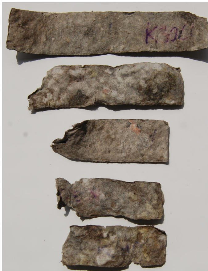
Obr. 36 vzorky materiálu po 6 týdnech v půdním prostředí, umyté a vysušené
