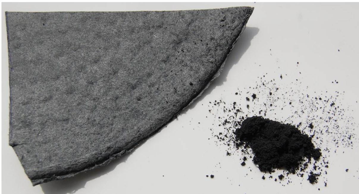
Obr. 32 ukázka vícesložkového kompozitu s uhlíkovými nanotrubicemi
