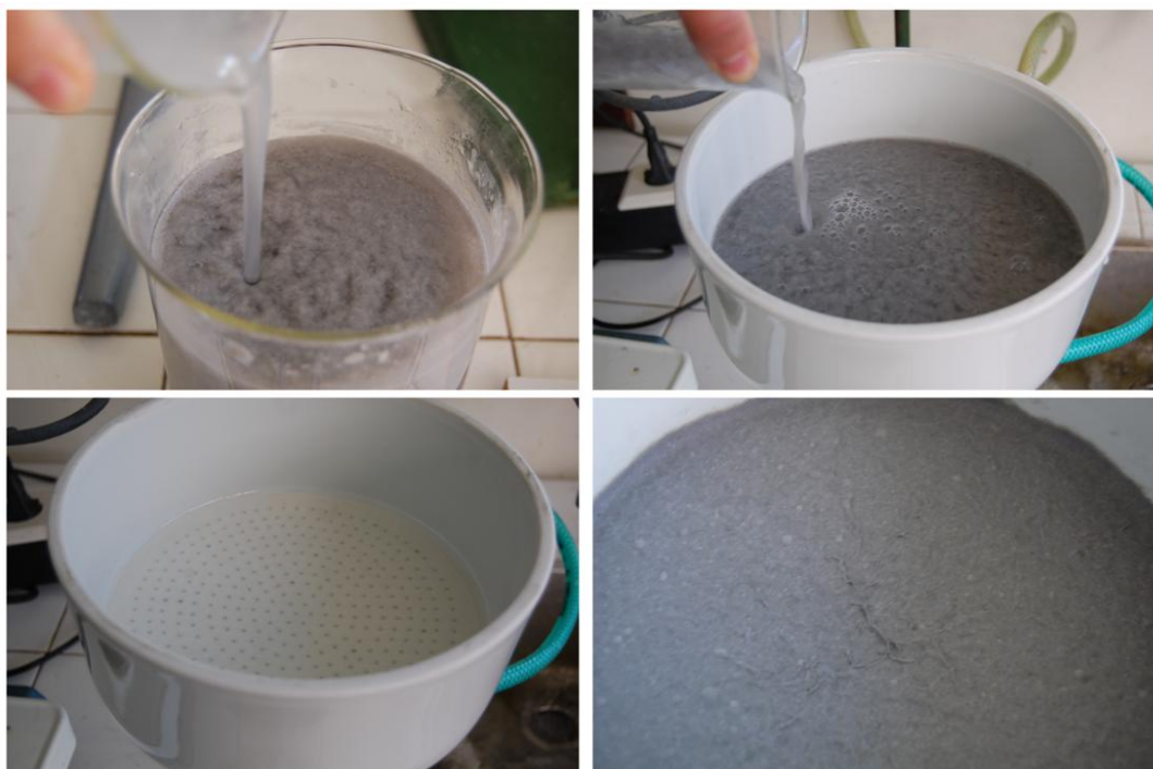
Obr. 18 snímky výrobního procesu - odsávání vodné suspenze
