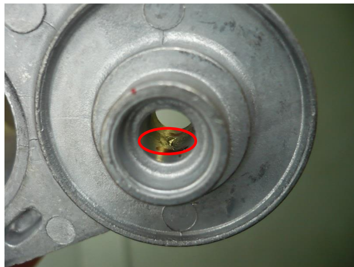
Obr. 13 – Příklad studeného spoje.
