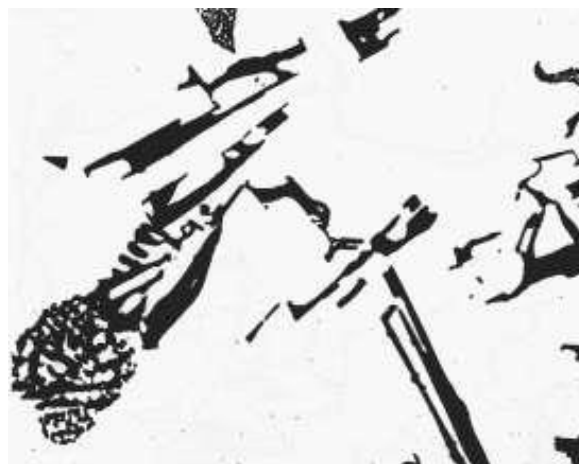
Obr. 7 – Potrojně eutektikum Al-Si-CuAl 2 . [2]
