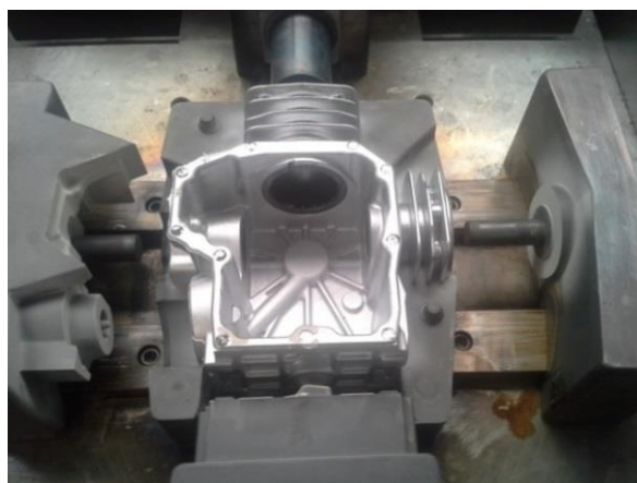
Obr. 40 – Uvzlý kus ve spodní polovině formy.
