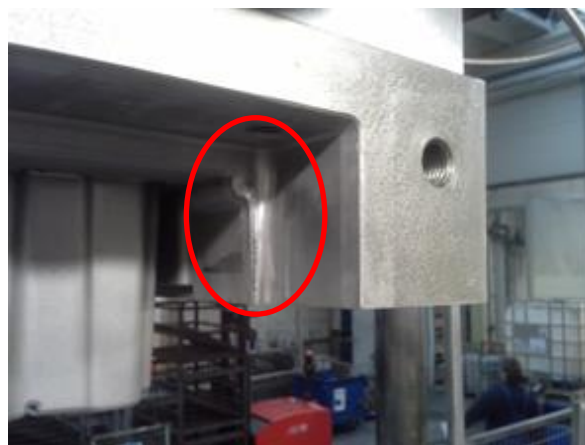
Obr. 37 – Ukázka vydřeného tvaru horní poloformy
