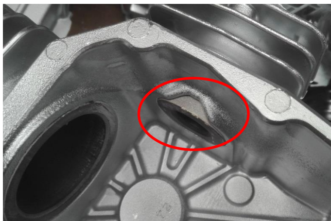
Obr. 44 – Nedolitý tvar u zálitku.
