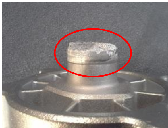
Obr. 39 – Rozdíl průměrů vtoku a keramiky z pohledu do formy a z nedolitého kusu.
