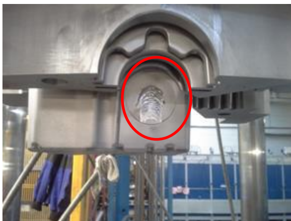
Obr. 37 – Ukázka vydřeného tvaru horní poloformy
