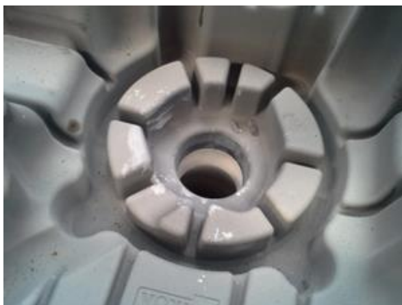
Obr. 39 – Rozdíl průměrů vtoku a keramiky z pohledu do formy a z nedolitého kusu.
