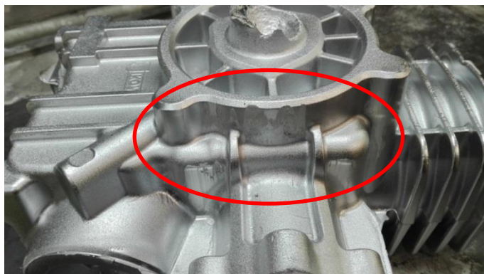
Obr. 47 – Vydřené tvary v blízkosti vtoku.
