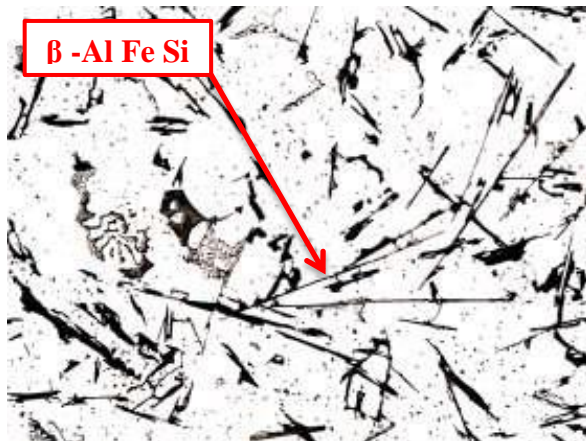
Obr. 5 – Jehlicová fáze \beta -AlFeSi. [2]
