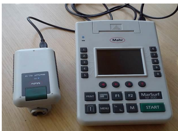
Obr. č. 65: Dotykový profilometr MarSurf M300
