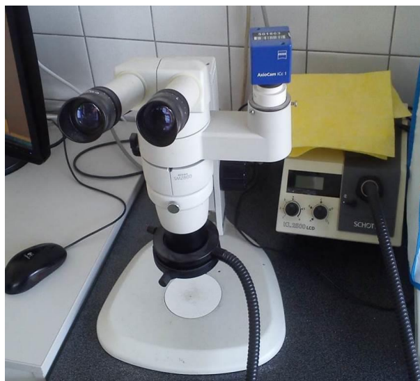
Obr. č. 71: Stereo lupa Nikon SMZ800
