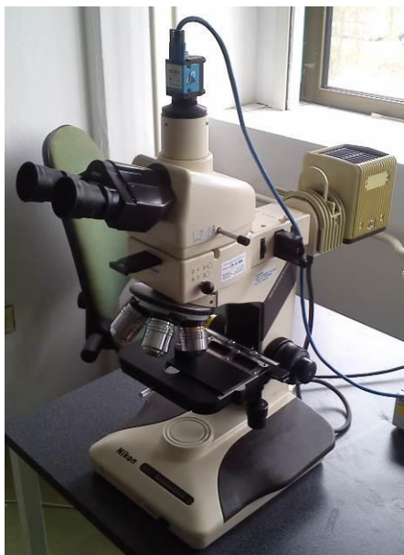
Obr. č. 70: Světelný mikroskop Nikon OPMPHOT-100
