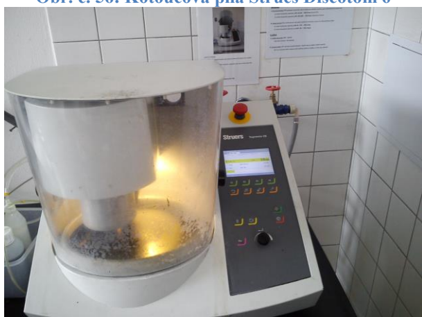
Obr. č. 58: Automatická bruska / leštička Struers Tegramin 20
