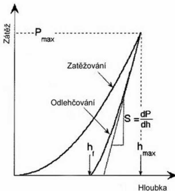
Obr. 11.: Indentační křivka elasticko-plastického materiálu, tj. závislost hloubky vtisku na velikosti zatížení. F_{max} je maximální zatížení indentoru, h_{max} je maximální hloubka vtisku, h_f je hloubka vtisku po odlehčení, S je sklon počátečního úseku odlehčovací křivky (převzato z [9])
