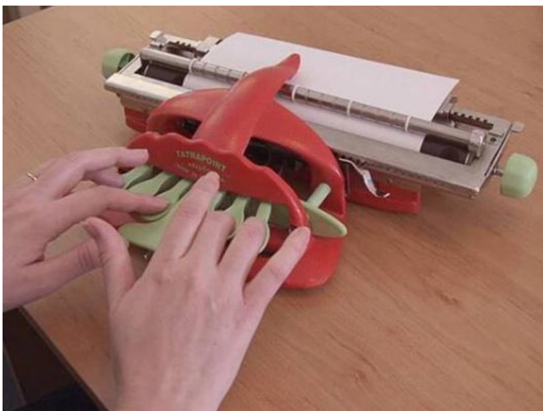
Obr. 2: Pichtův psací stroj: 6 kláves (jednotlivé body Braillova písma) + 1 klávesa na vyražení znaku a posun papíru.
