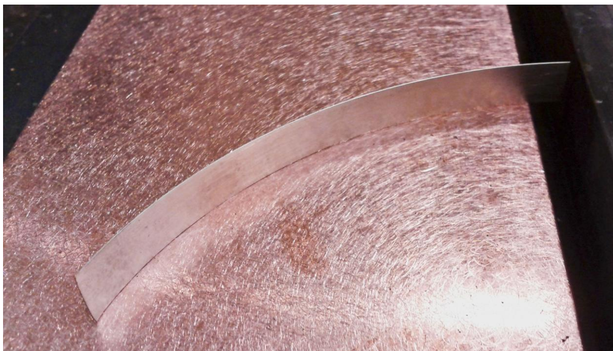
Obr. 21: Pájka Ag45CuZn ve formě plechu o tloušťce 0,2 mm
