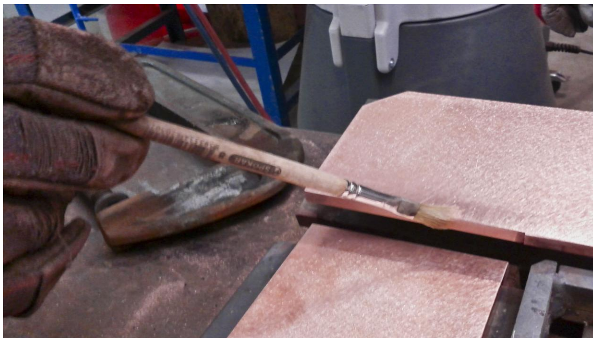
Obr. 20: Nanesení tavidla (zde tekuté tavidlo BF-103)
