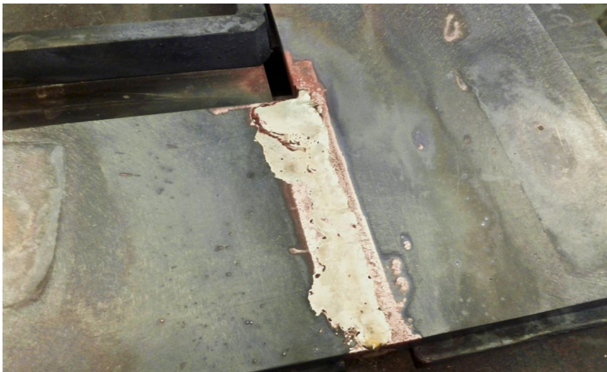
Obr. 28: Pájka ve spoji, okolí s nečistotami
