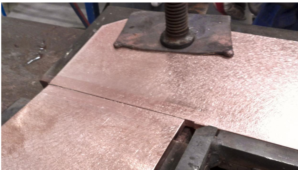
Obr. 23: Připravený materiál pro ohřev pomocí upínací svorky
