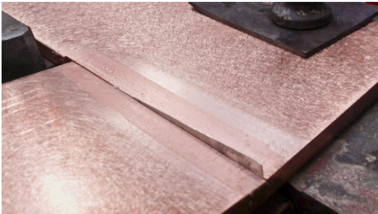
Obr. 22: Vložení pájky do mezery
