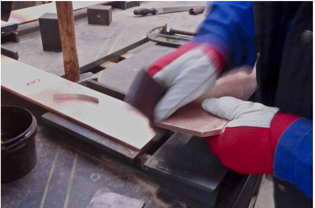
Obr. 19: Hrubé očištění ploch pro pájení pomocí smirkového papíru
