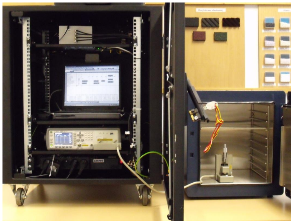
Obr. 3-8 Fotografie pracoviště pro měření frekvenčních charakteristik
