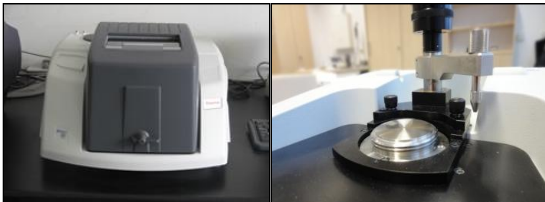
Obr. 3-9 Spektrometr Nicolet 380 v kombinaci s jednodrazovým ATR nástavcem MIRacle
