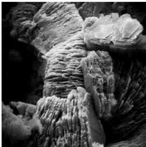
Obr. 13 SEM pohled na vrstevnatou strukturu přírodního fylosilikátového jílu [26]
