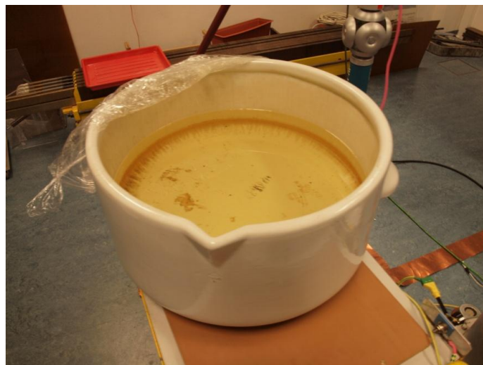
Obr. 4: Olejová lázeň pro zkoušení elektrické pevnosti
