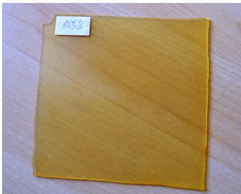
Obr. 9: Vzorek deskového tvaru o rozměrech 100 x 100 x 1 mm
