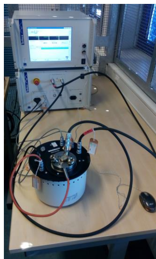
Obr. 6.2.4 Zapojení přístrojů Tettex 2830/2831 a Tettex 2903 během měření
