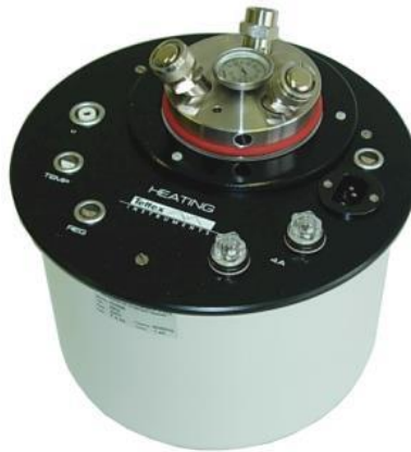
Obr. 6.2.2 Komora pro měření kapalných dielektrik Tettex 2903 [67]
