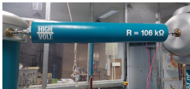
Obr. 6.1.6 Odpor pro omezení proudu při přeskožení
