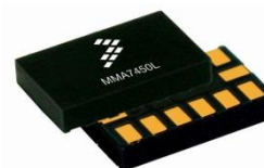
Obrázek 8: Pouzdro akcelerometru MMA7455.
