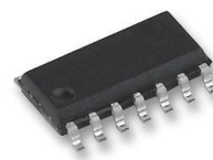
Obrázek 13: Pouzdro mikrokontroléru ATtiny24.
