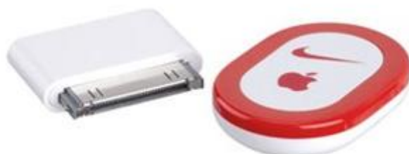
Obrázek 18 - Nike+ iPod Sport Kit (zásuvný modul a krokoměr)
