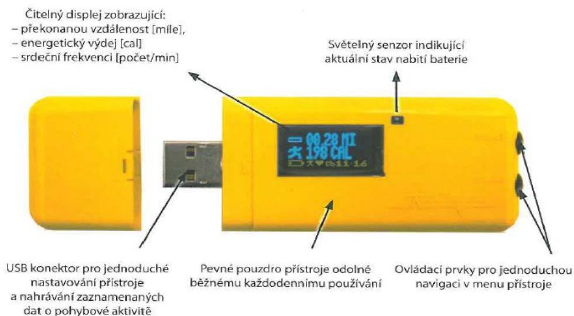
Obrázek 3 - Přístroj Actitrainer s popisem ovládacích prvků
