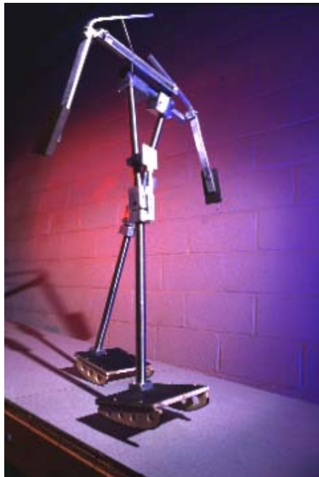
Obrázek 1.1.2: Pasivní dynamický chodící robot představený v [4]
