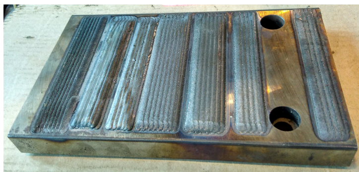
Obrázek 46: Skenovaný obrobek s testovacími svary
