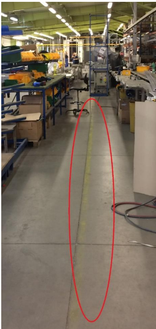
Obrázek 4-5: Nedostatečně viditelné bezpečnostní čáry
