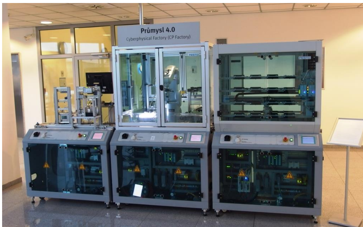
Obrázek 10: Model kyberfyzické továrny pro Průmysl 4.0 společnosti Festo Didactic 78
