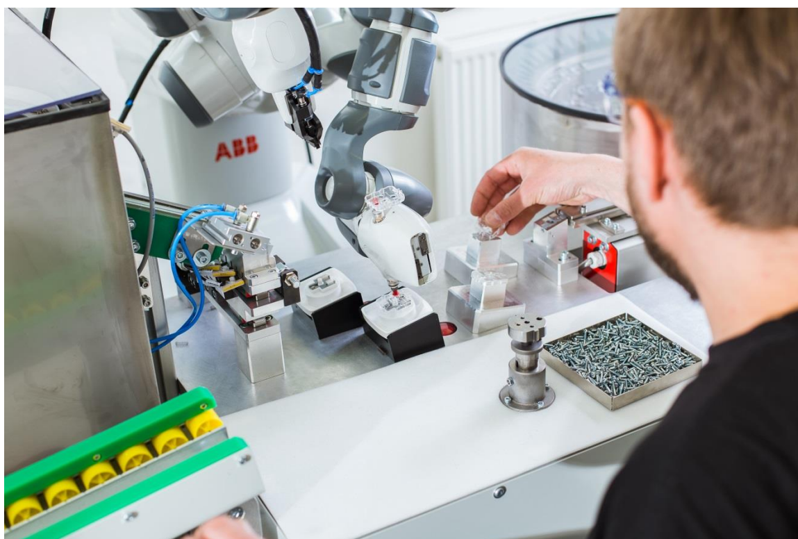
Obrázek 9: Spolupráce robotu YuMi a operátora při montáži zásuvky 73
