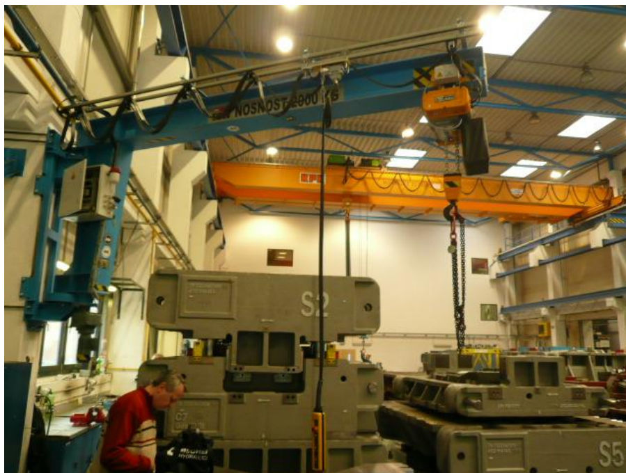
Obr. 8 Otočný konzolový jeřáb v kombinaci s mostovým [18]
