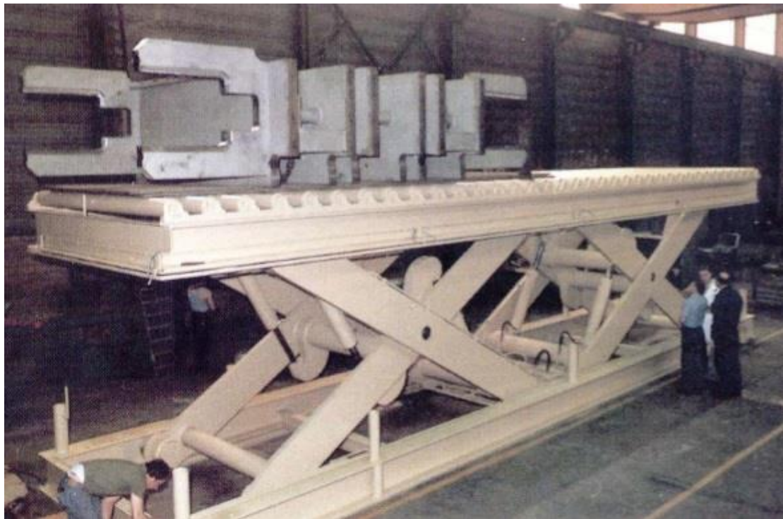
Obr. 16 Hydraulická zvedací plošina s válečky a odlitek [23]
