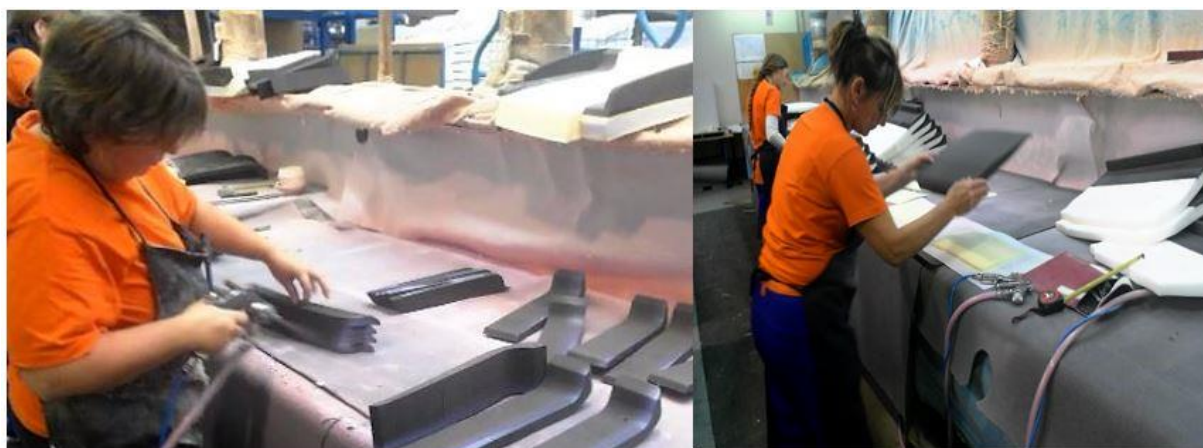
Obrázek 4-2: Nástřik lepidla a kompletace dílů
