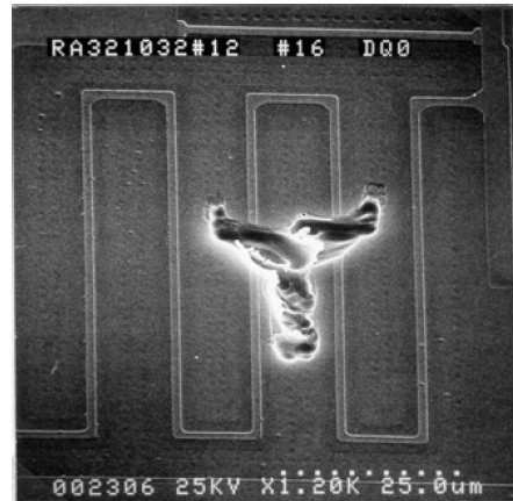
Obr. 2.5 Porucha struktury integrovaného obvodu vlivem ESD [5]
