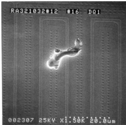
Obr. 2.5 Porucha struktury integrovaného obvodu vlivem ESD [5]
