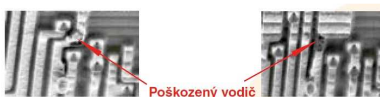
Obr. 2.6 Přerušený vodivý spoj – roztavením kovového vodiče [6]
