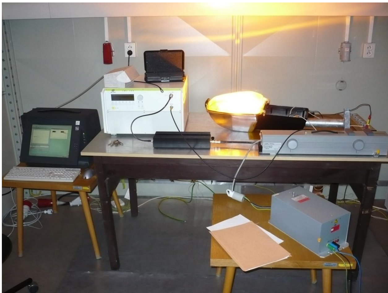
Obr. C 6. Měřicí pracoviště - měření odolnosti veřejného osvětlení (vysokotlaká sodíková výbojka s elektronickým předřadníkem)
