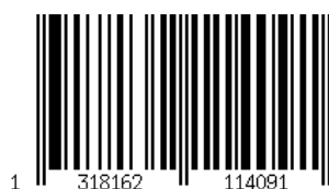
Obrázek 4 - Ukázka čárového kódu EAN (Zdroj [36])
