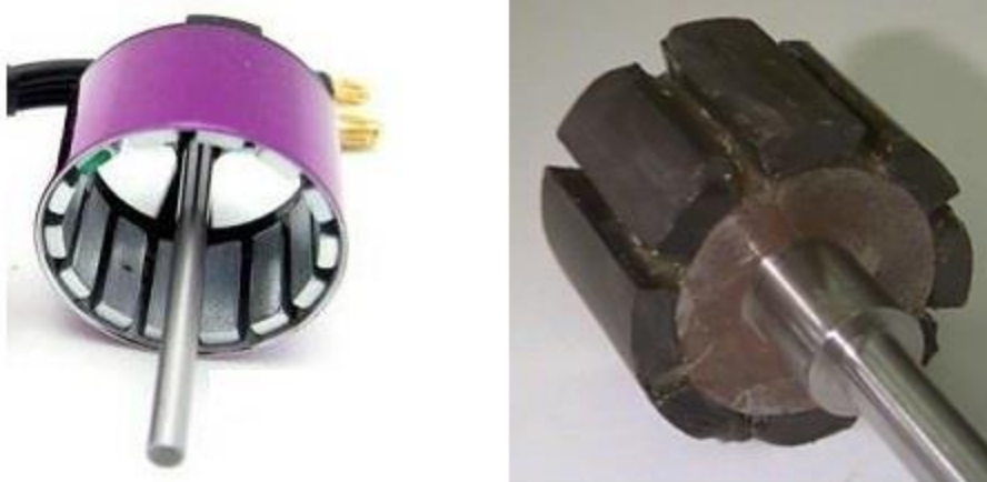
Obrázek 4: Rotory vlevo "outrunner", vpravo "inrunner" (upraveno z [2,5])
