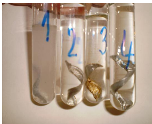
Obr. 34 Reakce Al s koncentrovanými kyselinami
