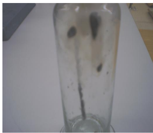
Obr. 38 Saze ve válci po redukcí hořčíkem
