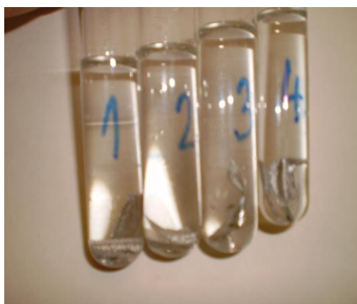
Obr. 33 Reakce Al se zředěnými kyselinami
