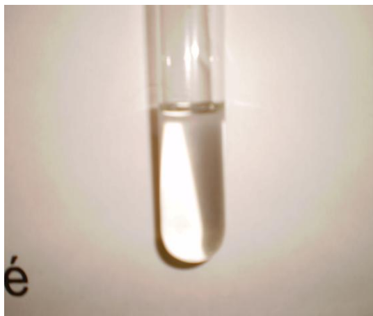
Obr. 11 Zkumavka s vodním sklem
