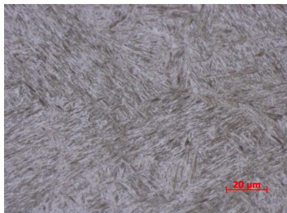
Obr. 8b: Naleptaná struktura – čep Sunrace při zvětšení 200x, leptáno Villela-bain
