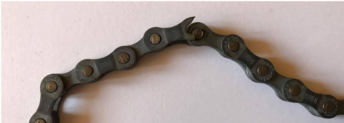
Obr. 29b: Řetěz SUNRACE po nitridaci, deformace v oblasti vnějšího článku
