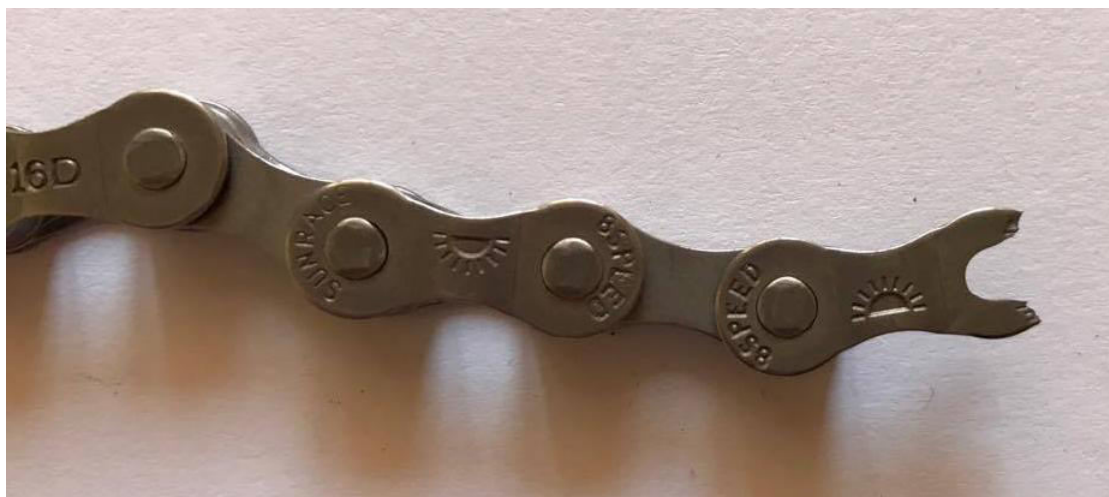
Obr. 29b: Řetěz SUNRACE po nitridaci, deformace v oblasti vnějšího článku
