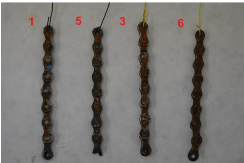
Obr. 36b: Korozní produkty - cementace
