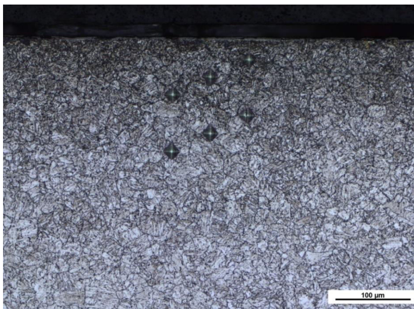
Obr. 31b:Provedení vtisků na výbrusu SUNRACE. zvětšení 200x, leptáno 3% nitalem
