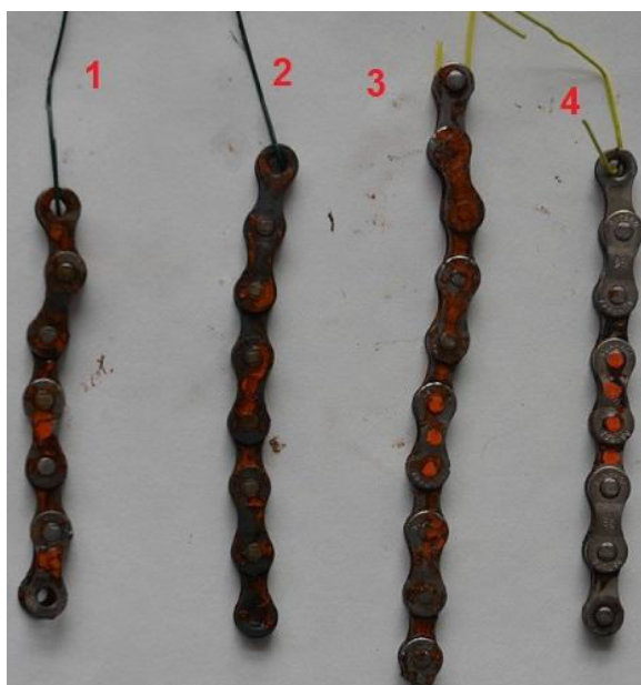
Obr. 34b: Korozní produkty - nitridace
