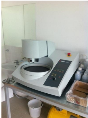
Obrázek č. 47: Automatická metalografická bruska a leštička Tegramin 30 od firmy Struers v Centru výzkumu Řež s.r.o. v Plzni
