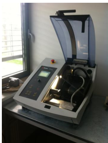
Obrázek č. 44: Automatická pila Accutom 100 od firmy Struers v Centru výzkumu Řež s.r.o. v Plzni
