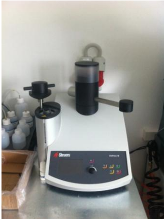
Obrázek č. 46: Automatický lis CitoPress 10 od firmy Struers v Centru výzkumu Řež s.r.o. v Plzni
