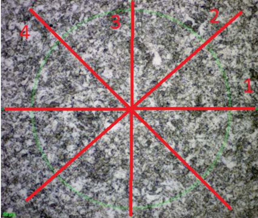
Obrázek č. 67: K49 Fe-9 Cr s výpočtovým terčem o poloměru 50 \mu\text{m} a 4 směry měření (podélný řez - zvětšení 1000 x) po elektrolytickém leptání v 5 ml \text{HNO}_3 + 10 ml HCl + 85 ml ethanolu po dobu 20 vteřin
