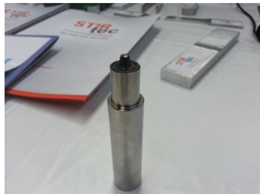
Obrázek č. 20: Rotační nástroj s cylindrickým ramenem a profilovaným kolíkem (trnem) pro třecí svařování s promíšením [14]
