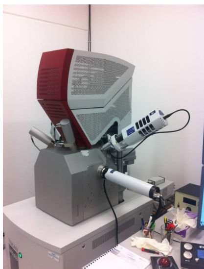
Obrázek č. 71: Skenovací elektronový mikroskop se zabudovaným energieově disperzním spektrometrem v Centru výzkumu Řež s.r.o. Plzeň
