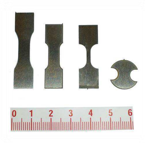
Obr. 33 Typy miniaturních zkušebních těles, zleva: a) Typ I, b) Typ II, c) Typ III, d) Typ IV (SFT)
