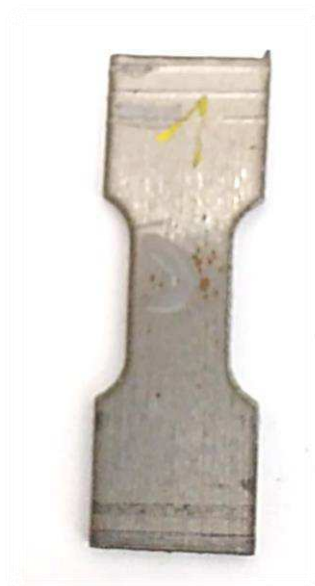
Obr. 31 Ukázka porušení vzorku typu II
