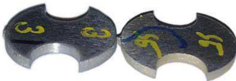
Obr. 34 Porovnání vzorků typu IV (SFT) před a po úpravě boků
