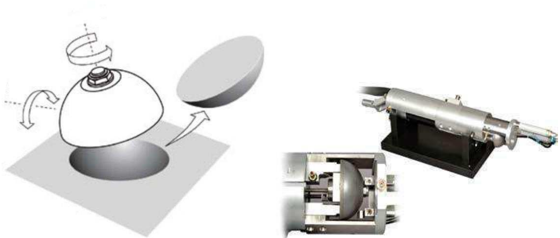
Obr. 16 Zařízení pro odběr vzorků Rolls Royce Ssam-2 a princip odběru vzorku [1]
