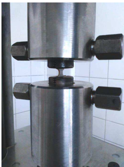
Obr. 37 Detailní pohled na vzorek SFT ve zkušebních čelistech
