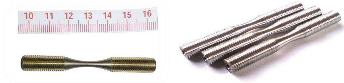
Obr. 28 Klasické zkušební těleso zatěžované jednoosým míjivým tahem
