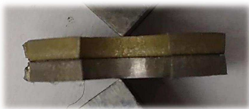
Obr. 35 Porovnání vzorků typu IV (SFT) před a po úpravě boků (pohled z boku)
