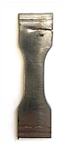
Obr. 30 Ukázka porušení vzorku typu I
