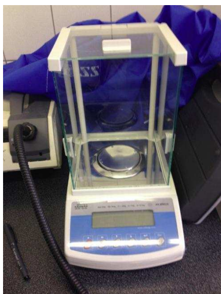
Obrázek 30: Váha, jež byla využita k měření váhy a váhových úbytků u jednotlivých vzorků
