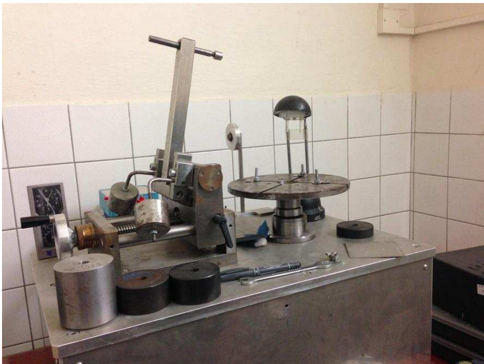
Obrázek 29: Zařízení pro tribologii na KMM ZČU
