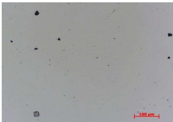
Obrázek 38: Vzorek B v podélném řezu, vyleštěný
