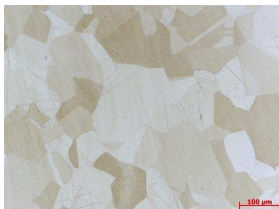
Obrázek 47: Vzorek B v příčném řezu, naleptaný
