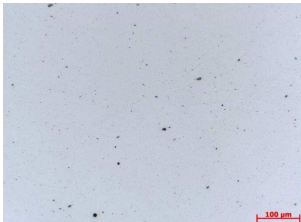
Obrázek 40: Vzorek C v podélném řezu, vyleštěný
