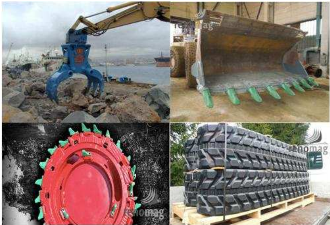
Obrázek 19: Příklady odlitků Hadfieldovy oceli [4]
