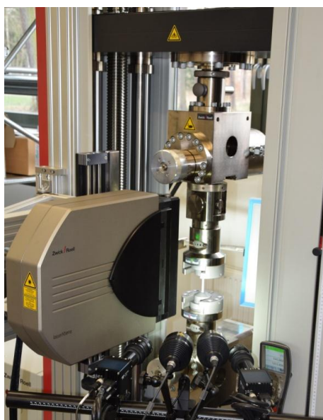
Obr. 26. – Vzorek upevněn ve stroji a připraven k experimentu
