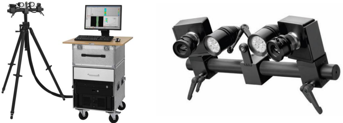
Obr. 23. – Kompletní příslušenství systému Aramis a detail na slider(kamery a světla) [19]
