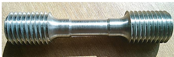
Obr. 17: Polotovar pro zpracování bez formy
