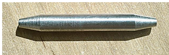
Obr. 18: Polotovar pro zpracování v dutině formy
