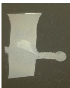
Obr. 32: Podélný řez odzkoušeným vzorkem-vpravo odzkoušený režim F_07 jen částečně vyplněná drážka
