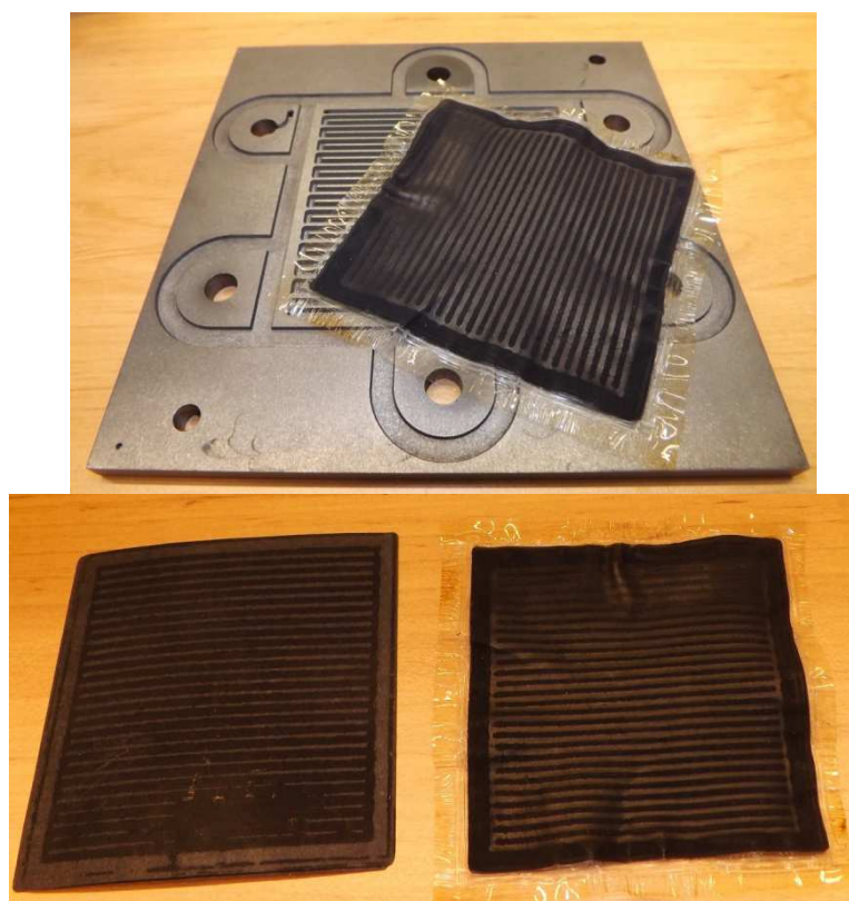
Obr. 27 – Fotografie vzorku MEA Paxitech post-mortem
