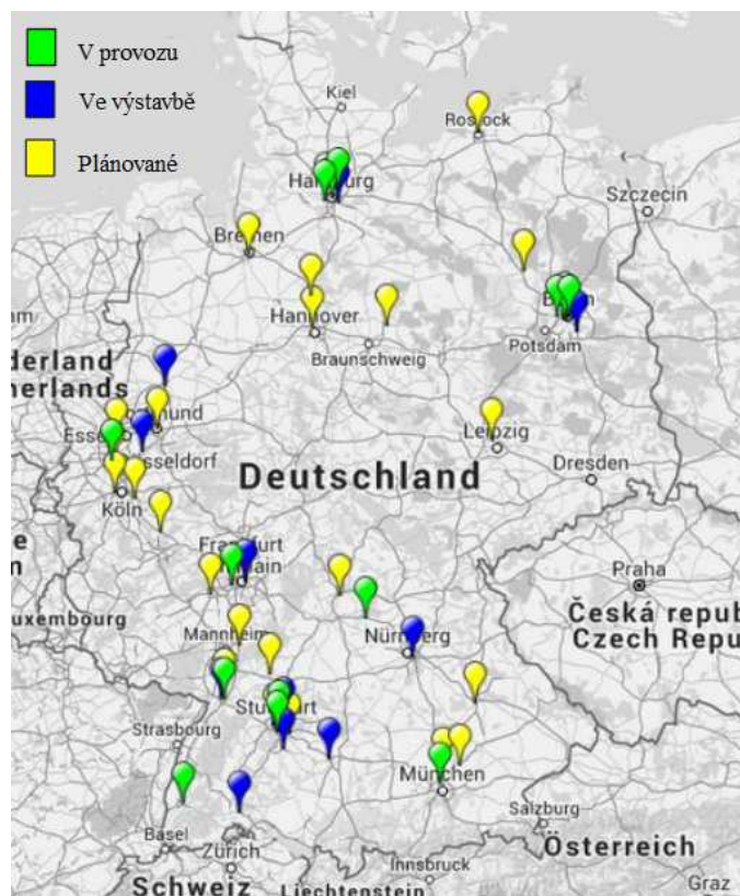
Obr. 5 – Současný stav vodíkových čerpacích stanic v Německu [5]
