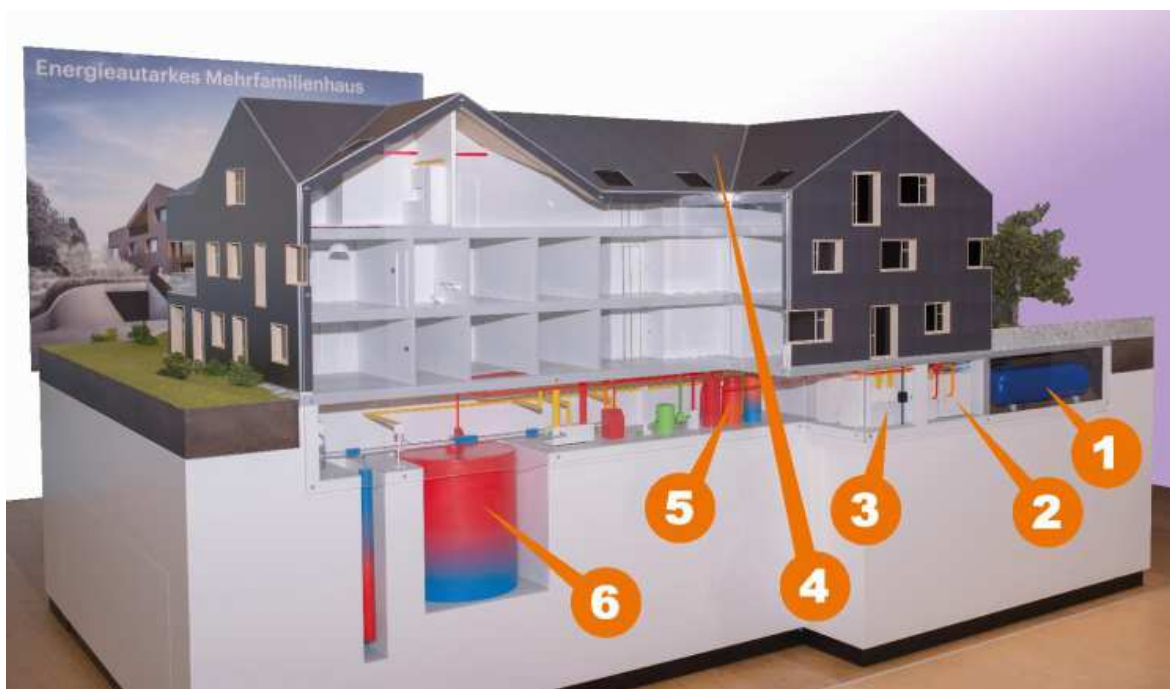
Obr. 2 – Řez soběstačnou budovou; kde lze vidět: 1) podzemní zásobník H_2 , 2) elektrolyzér (výrobek vodíku), 3) palivový článek (převod H_2 na el. energii a teplo), 4) fotovoltaické panely na střeše a stěnách, 5) ohřev teplé vody a systém vytápění, 6) zásobník tepelné energie [2]
