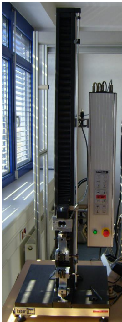
Obr. 26 Trhací zařízení Labor Tech
