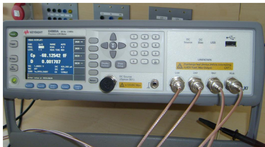
Obr. 19 LCR metr KEYSIGHT E4980A
