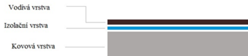
Obr. 7 Složení jednovrstvého IMS [20]
