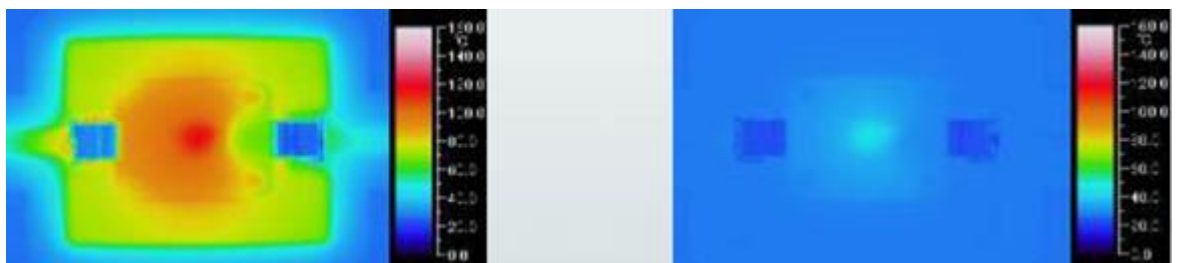
Obr. 6 Porovnání pracovní teploty FR4 vlevo a IMS vpravo [12]
