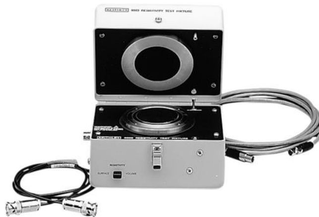
Obr. 23 Testovací komora Keithley 8009 [34]
