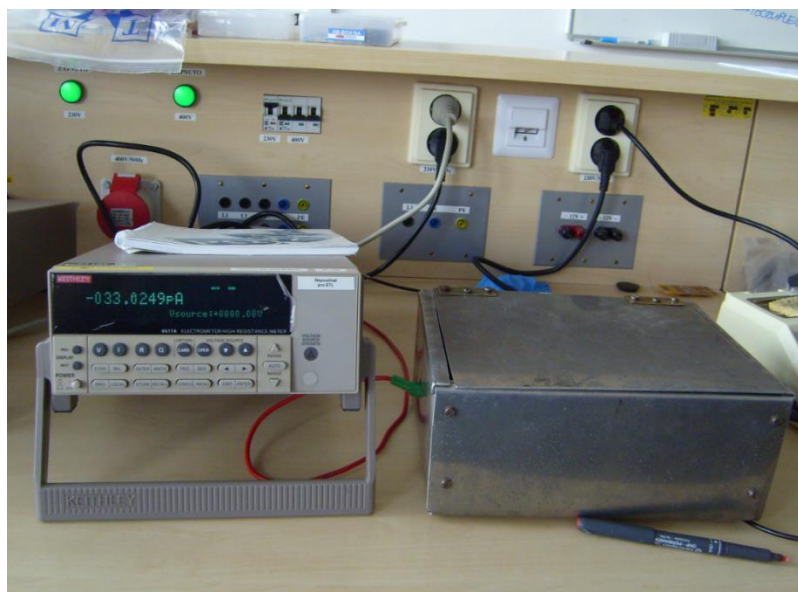
Obr. 20 Elektrometr KEITHLEY 6517A se stínícím boxem
