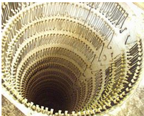
Obr. 7 Ukázka šachtové pece osazené topnicemi uvnitř pláště. [13]
