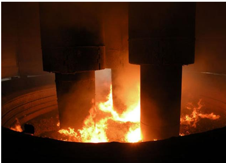
Obr. 18 Pohled do pece se zakrytým obloukem [22]
