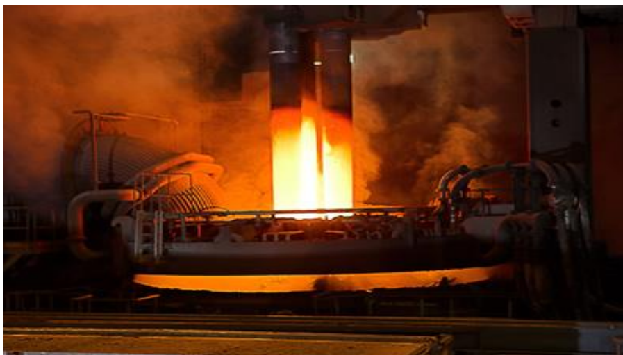
Obr. 17 Ukázka elektrod obloukové pece s nepřímým obloukem [23]
