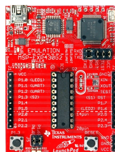
Obr. 10: Procesor MSP430G2553 v launchpadu
