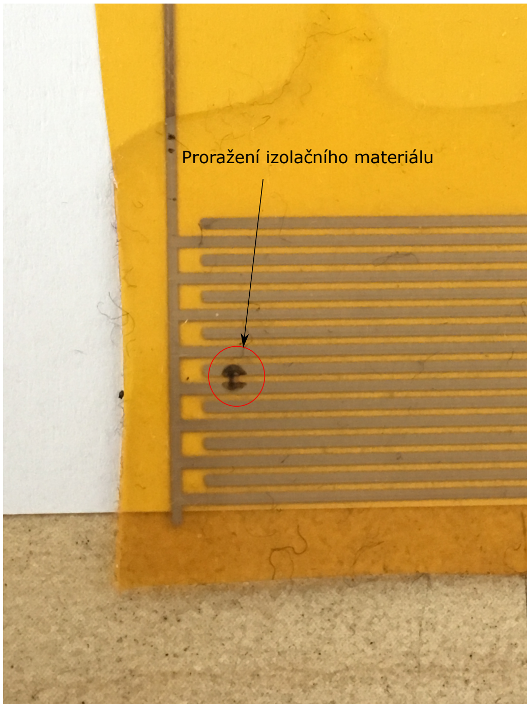
Obr. 36: Proražení izolačního materiálu (silikonu) mezi elektrodami
