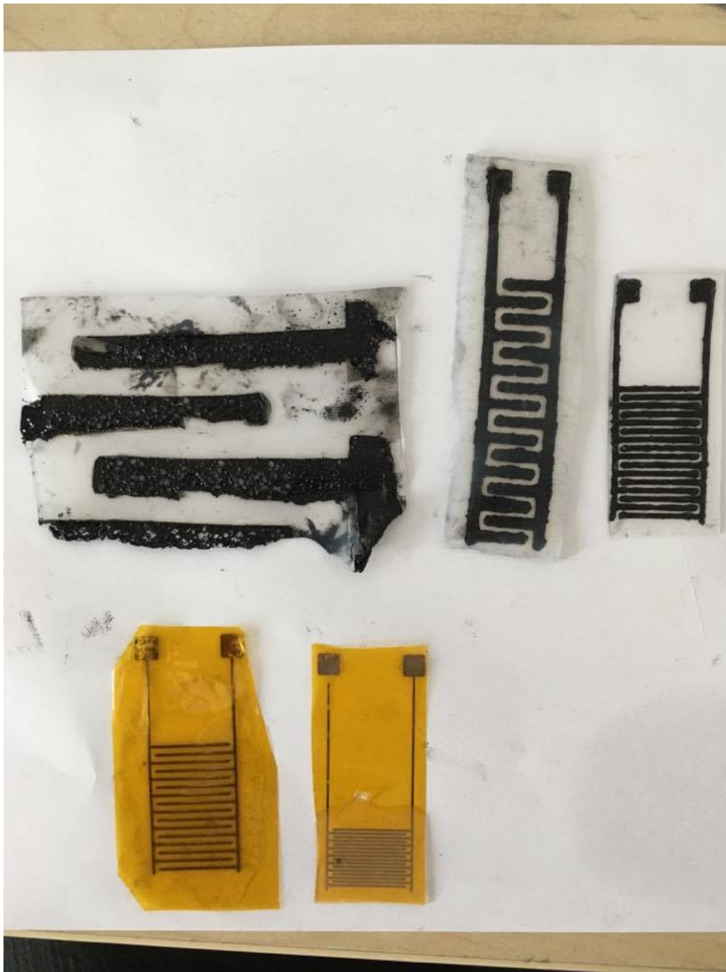
Obr. 37: Postupná miniaturizace prototypů, horní řada elastická fólie, dolní řada flexibilní fólie
