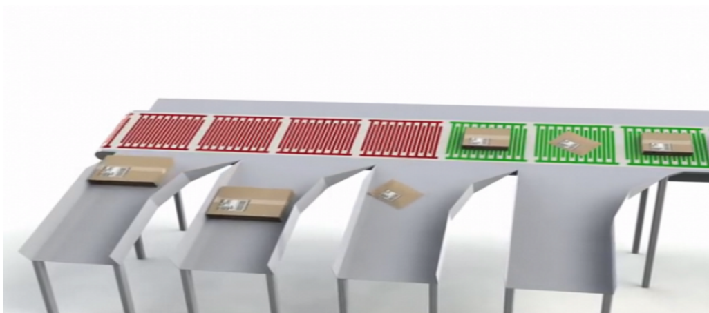
Obr. 29: Inteligentní dopravníkový pás využívající elektroadhezi [3]
