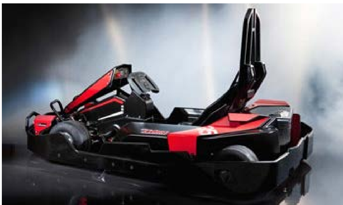
Obr.23: Elektrická motokára OTL [18]
